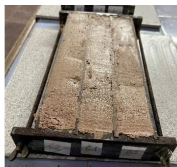
Figura 2 - Dosificaciones empleadas para evaluar la retracción lineal de las mezclas para adobes y probetas de las series A 50, estabilizadas con arena y paja.
