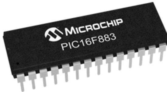
FIGURA 3.1 – Imagen Microcontrolador PIC16F883
