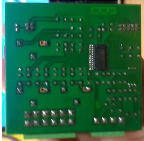
FIGURA 7.3 – Placa ADE 7758 fabricada a partir del diseño realizado, vista inferior.
