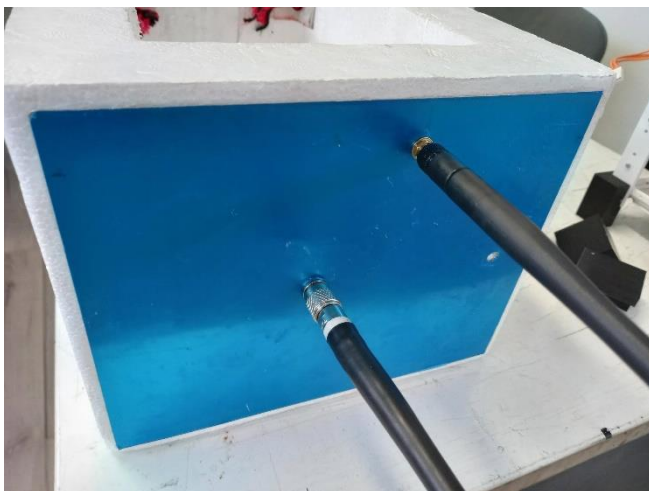
Figura 33 - Construcción de Antenas y Plano de Masa
