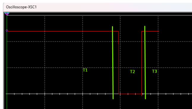
Figura 50 - Simulación de Corto Circuito
