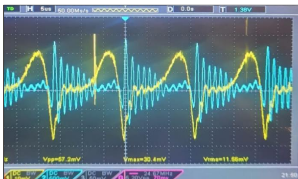
Figura 67. Respuesta subamortiguada del amplificador de transconductancia.
