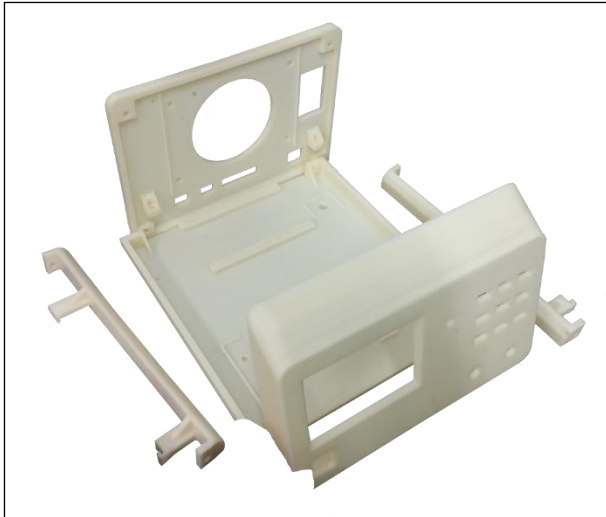
Figura 52. Vista de la estructura finalizada su impresión.
