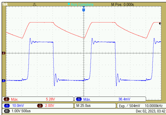
Figura 78. Señal cuadrada de 10Khz. Capacitor 51pF.
