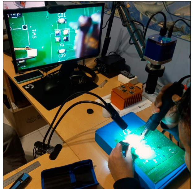
Figura 37. Soldado de componentes mediante la utilización del microscopio.
