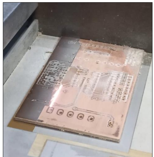
Figura 41. Grabado laser de la placa de control.
