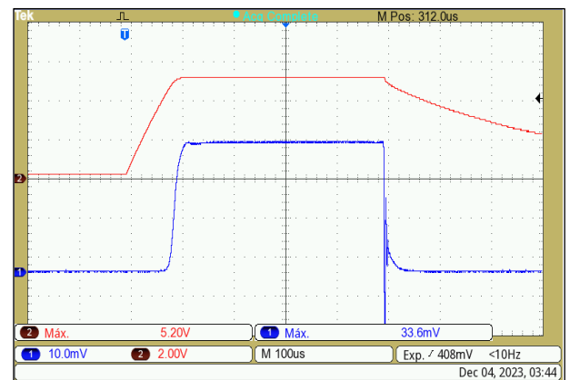
Figura 81. Respuesta al pulso. Capacitores 330pF
