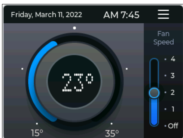
Figura 60. Control de temperatura diseñado con la librería LVGL.
