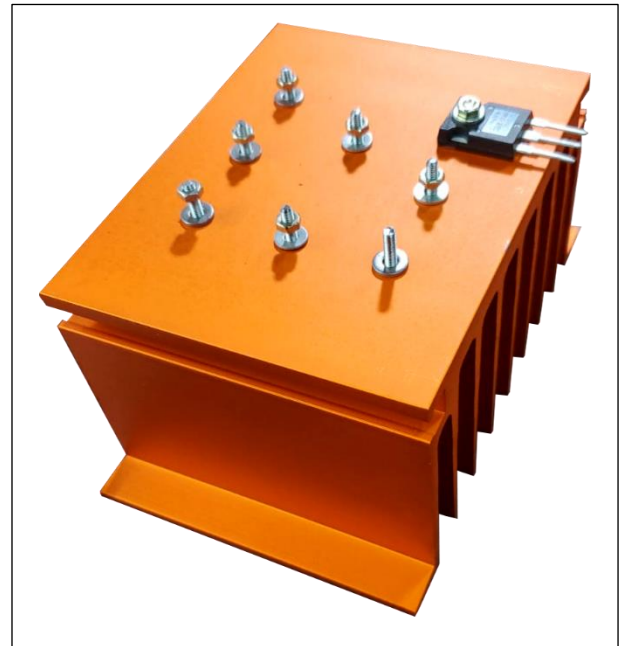
Figura 45. Proceso de colocación de los mosfets en el disipador.
