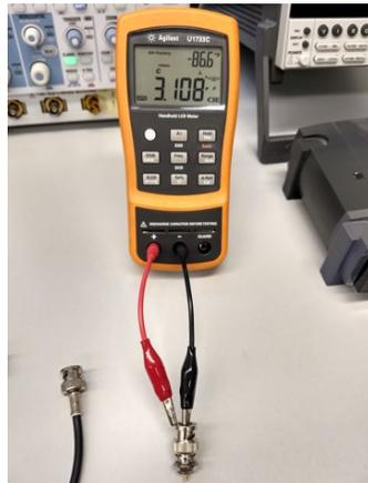
La medición de las copas se realizó de la misma manera. Un ejemplo es la siguiente imagen de la copa utilizada para cable coaxial:
