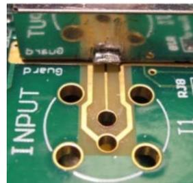
Hay que tener presente que la guarda elimina la capacitancia generada en las pistas y cables triaxiales, pero la capacitancia de entrada intrínseca del amplificador no se puede eliminar, por lo que con los métodos de medición se determinará la capacitancia de entrada total.
