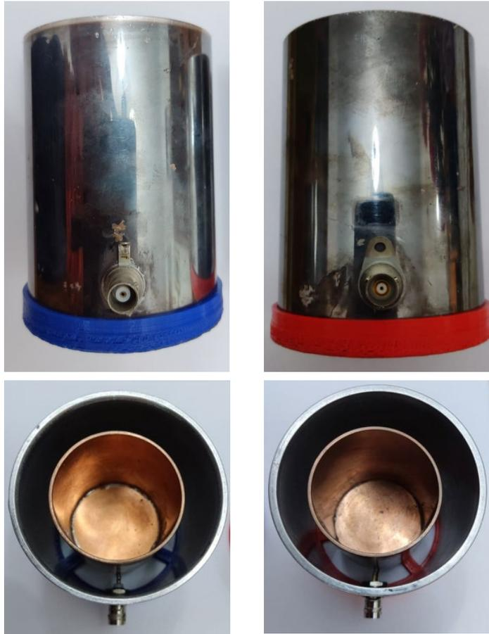
Por otro lado, se construyó una caja de prueba blindada, que permite tanto conexión coaxial, como triaxial. Esta será utilizada para los métodos de medición de impedancia de entrada del detector, de modo que los dispositivos pasivos conectados en su interior están aislados de posibles acoplamientos electromagnéticos y ruidos del exterior. Los dispositivos pasivos se conectan a través de borneras.
