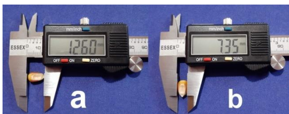
Figura 1: Medida de (a) longitud y (b) ancho de un grano de maíz con calibre digital
