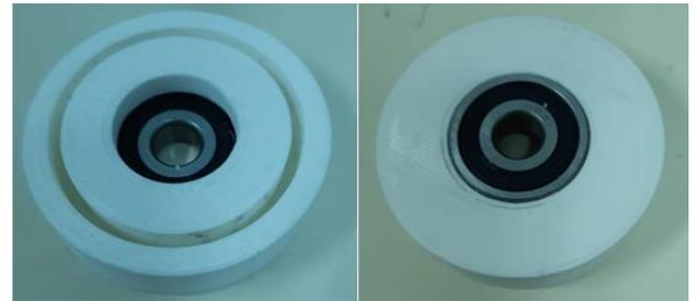
Figura 7: Acoplamiento cilindro-rodamiento.
