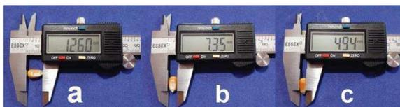
Figura 1: Determinación manual del largo (a), ancho (b) y espesor (c).
