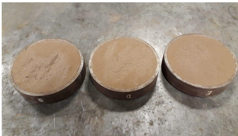
Figura 12. Probetas luego del ensayo a la erosión, de izq. a der.: “A”, “A+DO” y “A+DO x2”. Fuente: elaboración propia
