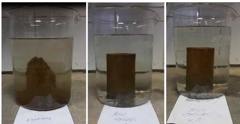
Figura 10. Probetas de la “Situación A” (izq.), “Situación A+DO” (centro) y “Situación A+DO x2” (der.) luego de 10 minutos de sumergidas. Fuente: elaboración propia
