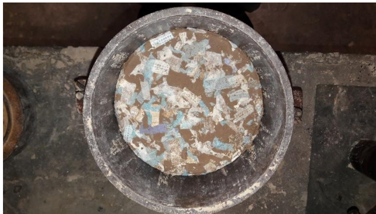
Figura 8. Superficie de probeta de VSR con contenido de barbijos cercano al óptimo (elaboración propia)
