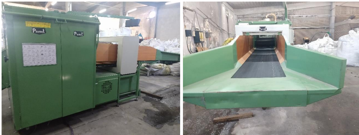
Figura 2. Guillotina utilizada en la trituración de prueba (elaboración propia)
