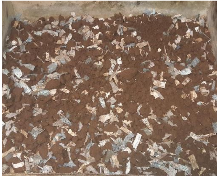
Figura 6. Mezcla de suelo y barbijos en su Humedad Óptima (elaboración propia)
