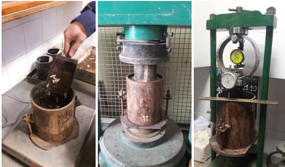
Figura 7. Proceso de Ensayo de VSR con moldeo a densidad prefijada (elaboración propia)
