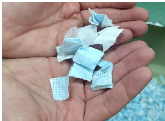
Figura 4. Producto resultante del triturado de prueba (elaboración propia)
