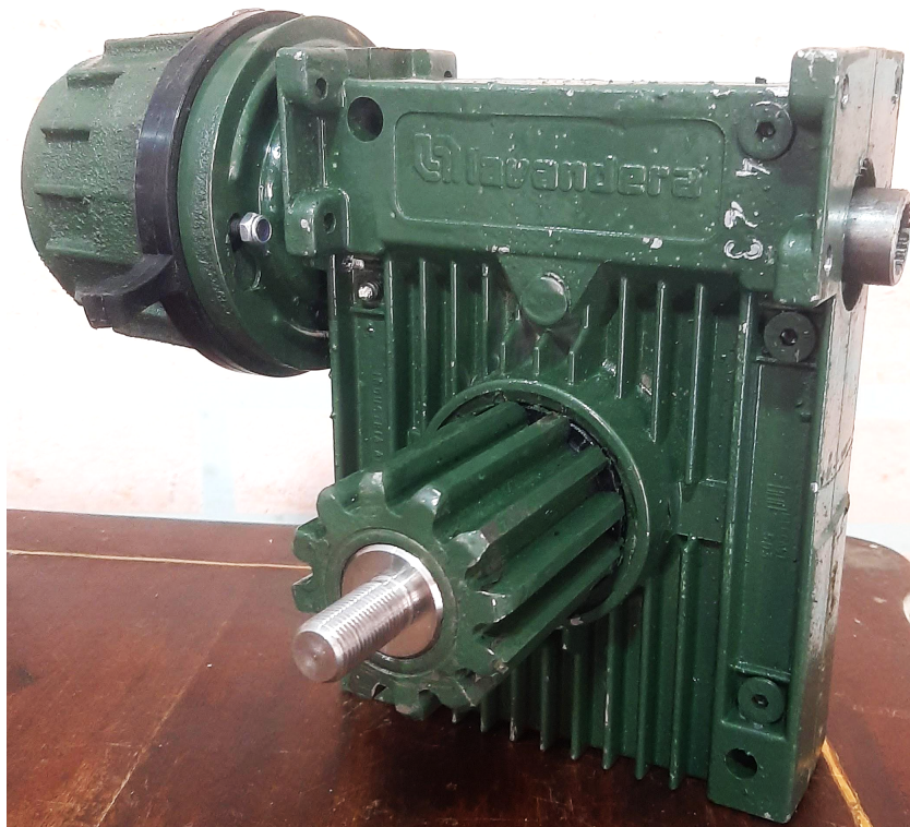
Figura 26. Conjunto reductor - freno. Lavandera
