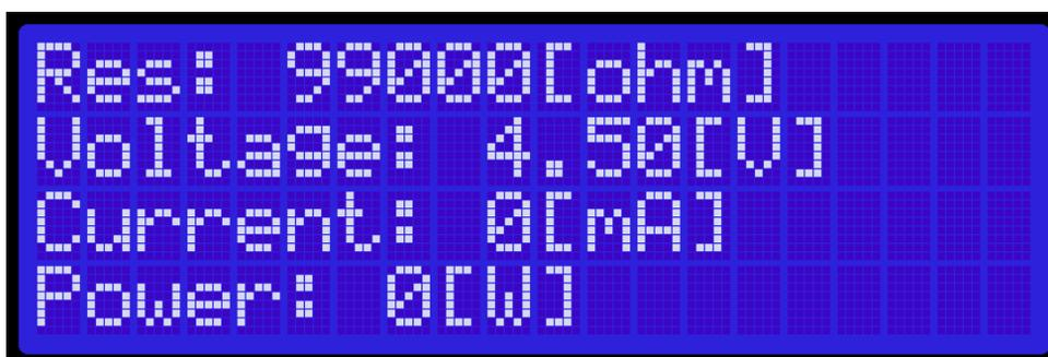
Figura 3.12: Contenido del display en modo standby
