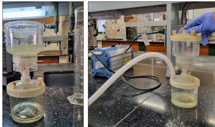
Figura 13. Montaje del equipo de filtración
