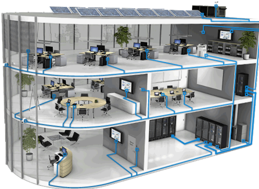
Figura 4.1.4 Sistema de cableado estructurado vertical y horizontal.
