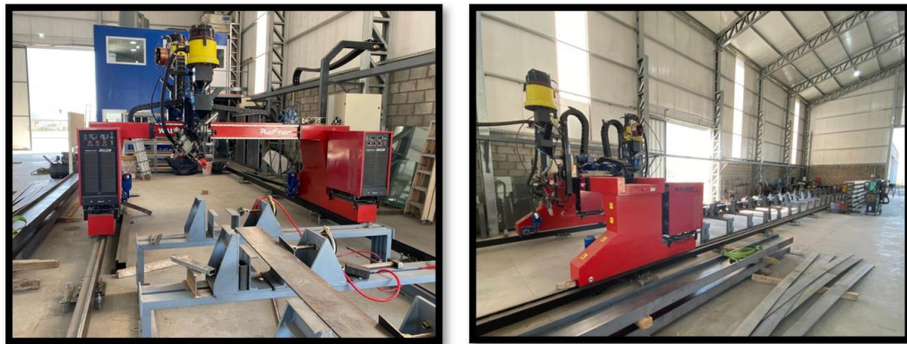
Figura N°47: Equipo de soldadura para vigas de alma llena.
