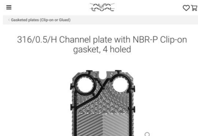
Figura 9 - Placa intercambiador comercial
