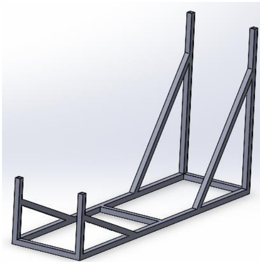
Figura 127: Patas de la banda transportadora.
