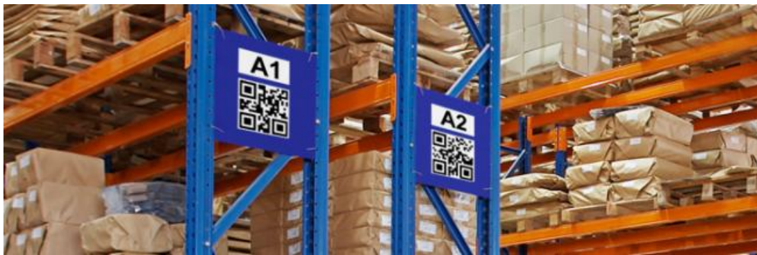
Fig. 2.5 Uso de códigos QR para ubicación dentro de un depósito
