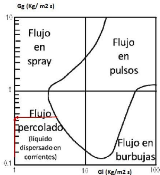
Gráfica 6.7: Diagrama de SATO para determinación de tipo de flujo - Fuente: "Elementos de ingeniería de las reacciones químicas" 4ta edición. Autor: H. Scott Fogler
