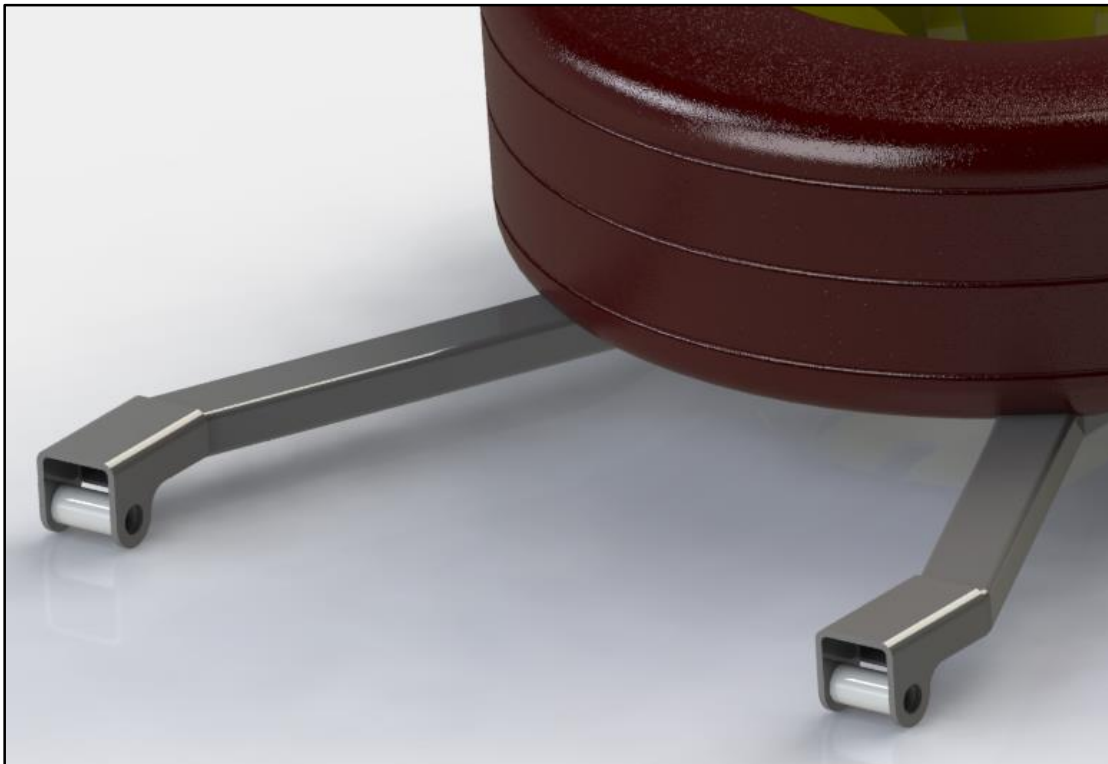
Figura 130: Posición de bisagras móviles en el bastidor.
