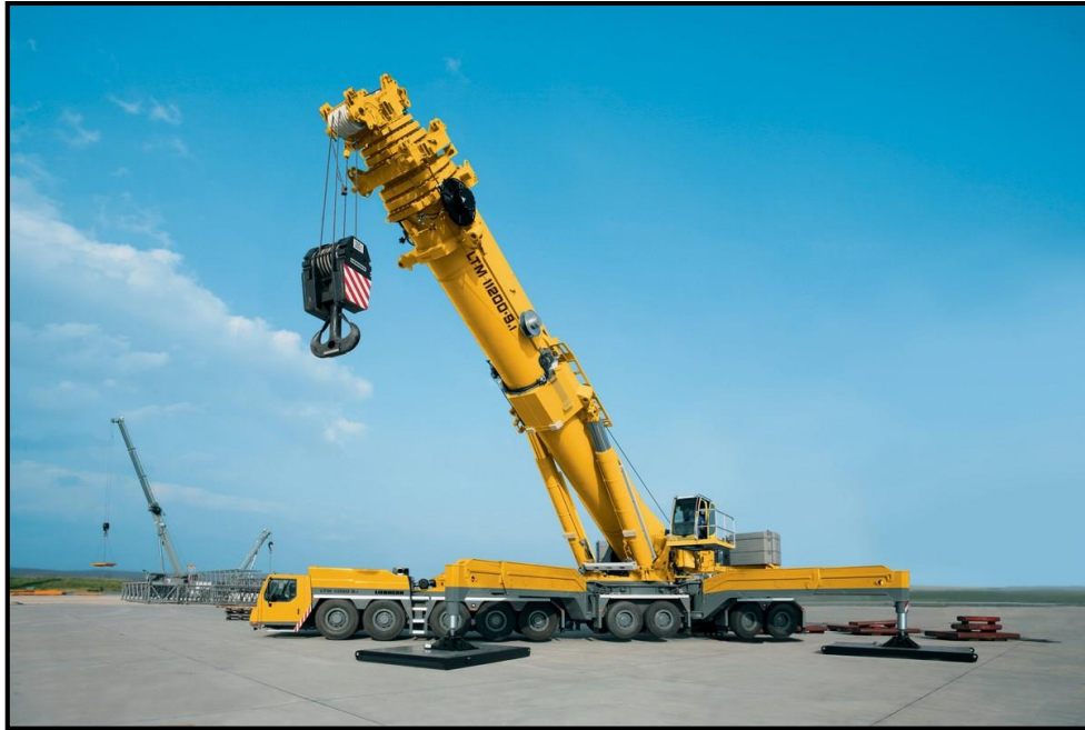
Figura 7: Grúa LTM 11200-9.1 Desplegada.
