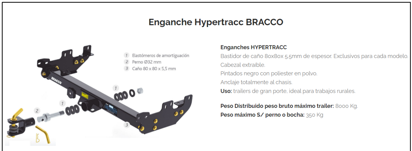
Figura 121: Detalle de enganche Hypertracc BRACCO.
