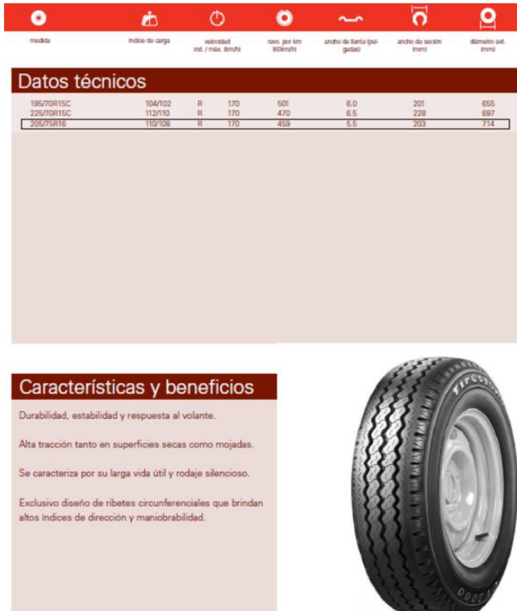
Figura 113: Características de las cubiertas seleccionadas.
