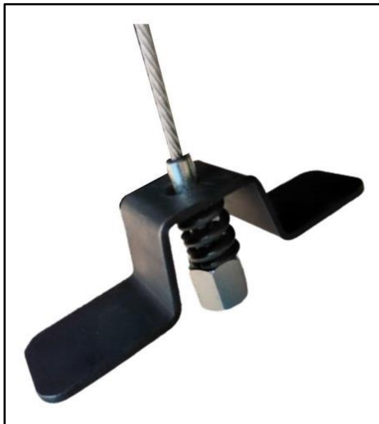
Figura 136: Detalle de enganche de malacate ensamblado.
