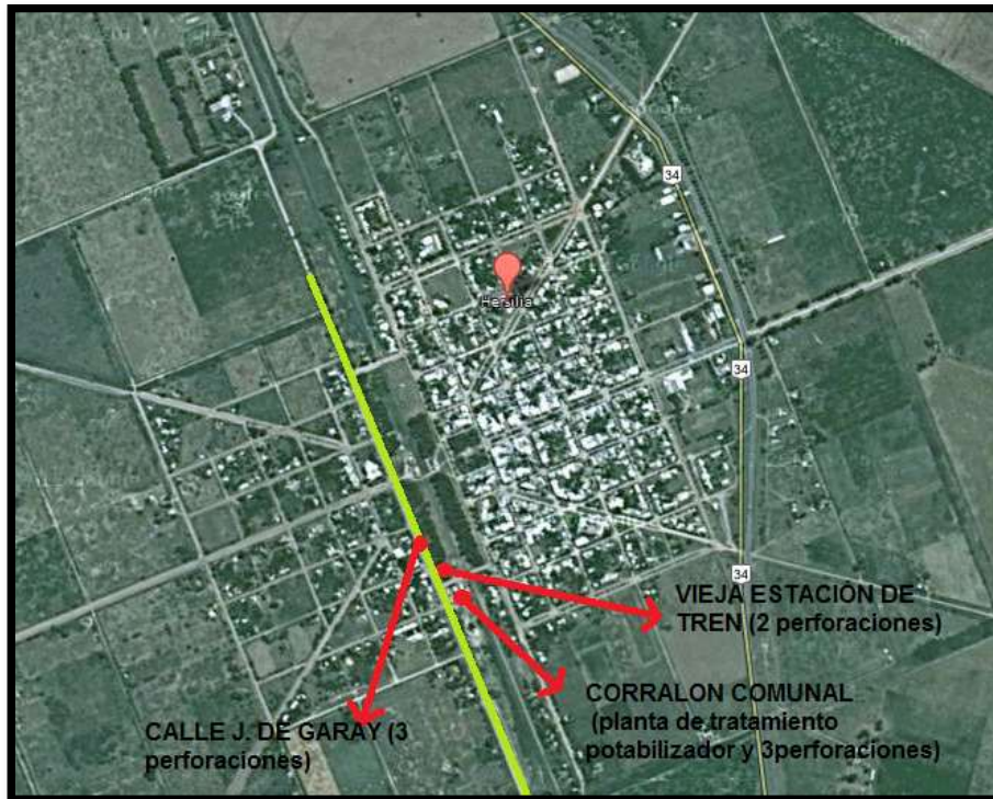
Figura 2.3- Distribución de Obras de Toma de Agua.
