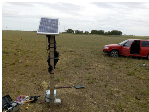
Figura 4.16: Nodo cubierto con nylon para evitar el traspaso de agua en caso lluvia
