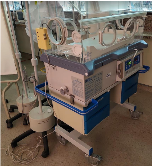
Figura 7-7. Instalación de estación en incubadora Medix PC-305.
