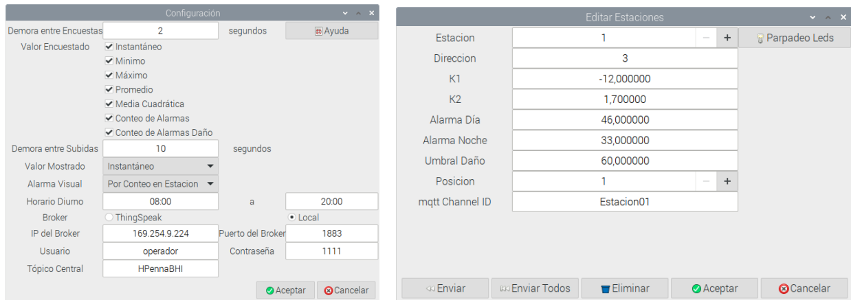
Figura 4-34. Configuración para la Estación Central y la Estación de medición del ejemplo.
