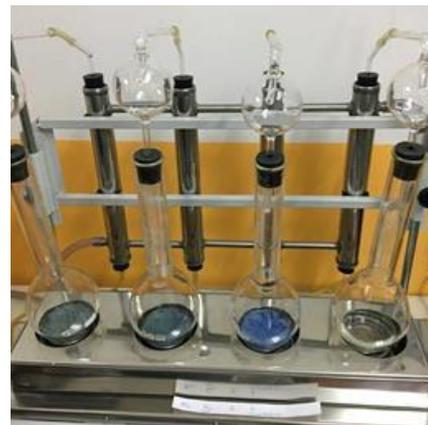
Figura 3: Destilación de muestra digerida
