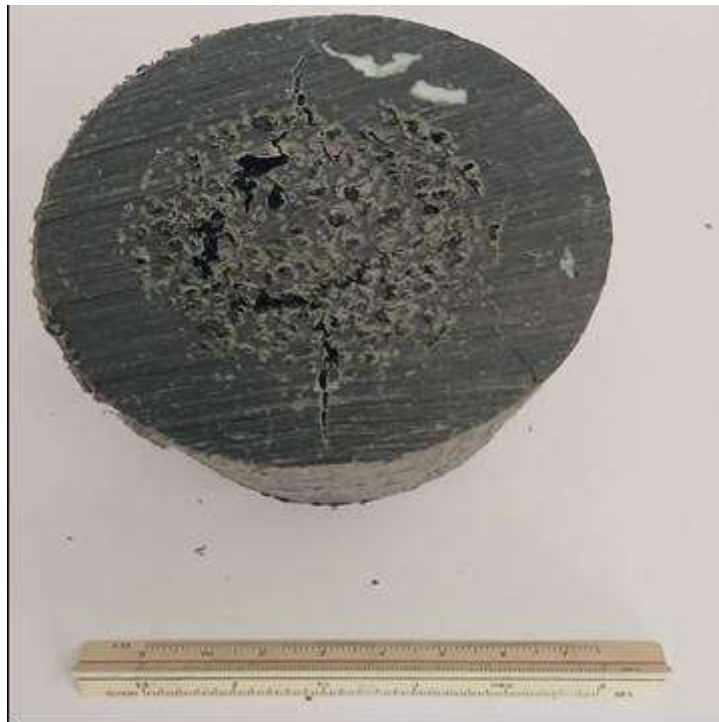
Figura 6: Detalle fisuras y variación en el diámetro probeta 3
