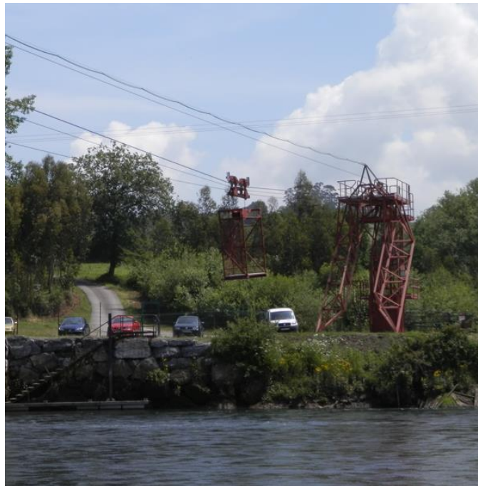
Figura 9.d: Blondin transporte para kiwis y materiales en la isla del Rio Nalon
