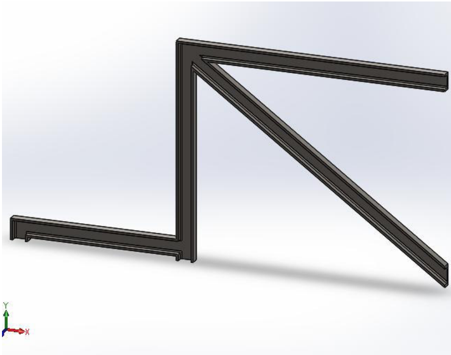
Figura 43. Soporte tanques de agua
