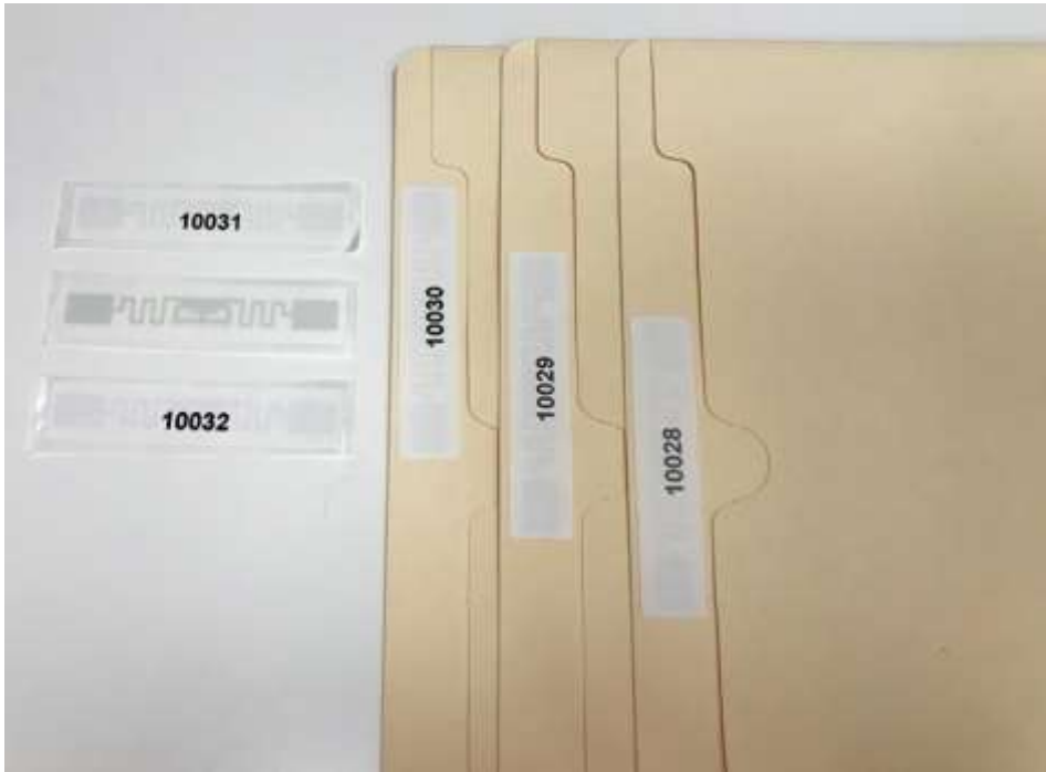
Figura 17 cómo se colocaría el tag para identificar un expediente. ( https://www.atlasrfidstore.com/rfid-insider/findmyfiles-rfid-file-tracking-for-patient-files-case-files-car-titles-more/ , 2023)
