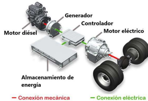
Figura 1: Esquema del tren de potencia y sistema de almacenamiento de un bus híbrido serie (adaptado de [2])
