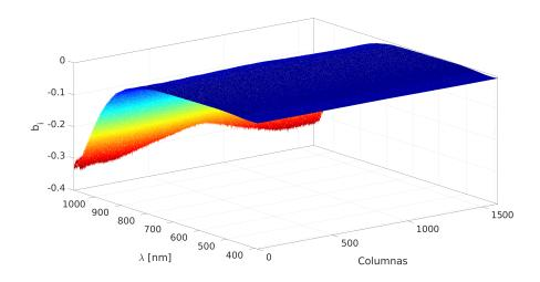
**Fig. 7.5**: Coeficientes de calibración  $b_i$  ( $t_{int} = 5ms$ ).
