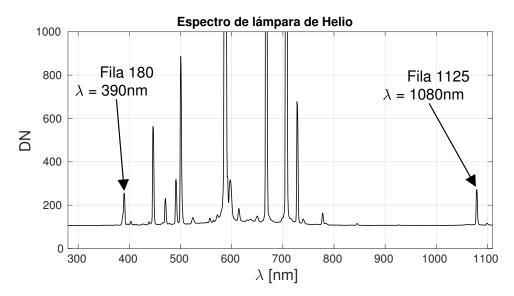
Fig. 6.19: Rango espectral determinado a partir de la lámpara de Helio.
