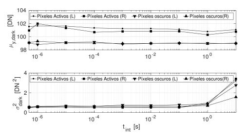
**Fig. 5.19**: Media y varianza de la señal oscura en función del tiempo de integración para 2 ADC.
