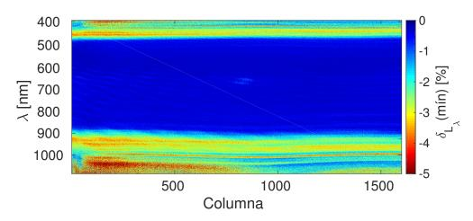
**Fig. 5.6**: Desviación de la linealidad  $\delta_{\lambda}(min)$  con la radiancia.
