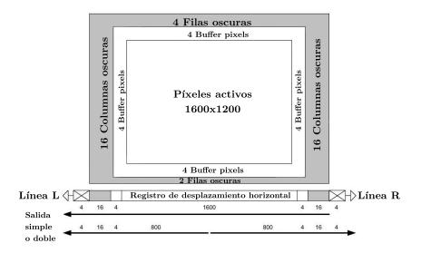
**Fig. 3.9**: Estructura del sensor KAI-2001.
