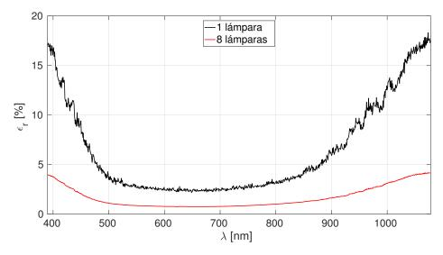
Fig. 7.10: Error relativo de la radiancia, 1 y 8 lámparas, 5ms. (columna 800).
