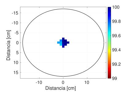
**Fig. 4.9**: Área medida en el puerto de salida de la esfera donde se ve la matriz de 13 puntos medida.
