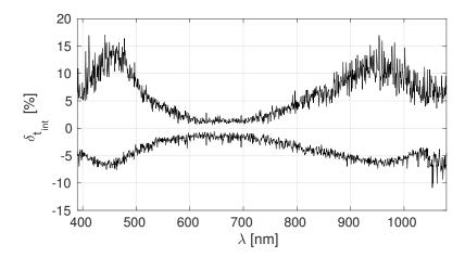
**Fig. 5.7**: Desviación de la linealidad  $\delta_{t_{int}}$  con el tiempo de integración para la columna 800.
