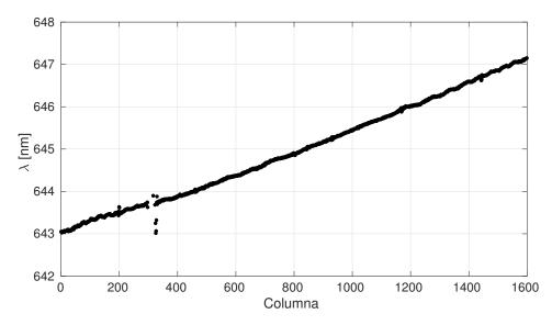
**Fig. 4.15**: Resultado de la calibración espectral realizada con el monocromador, lo que lleva a concluir erróneamente que existe una desalineación entre espectrógrafo y cámara pco.1600.
