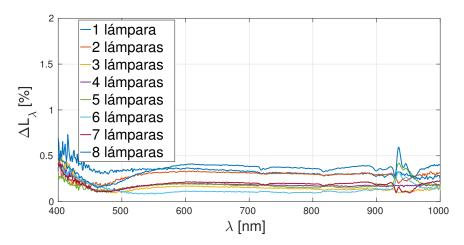
**Fig. 4.11**: Uniformidad espacial de la radiancia en el puerto de salida de la esfera integradora en el rango de longitudes de onda de la cámara hiperespectral.
