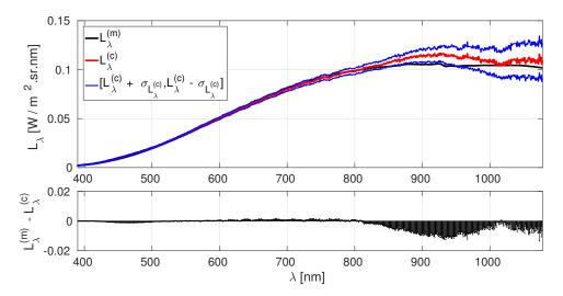
**Fig. 7.8**: Calibración realizada en una imagen con  $t_{int} = 5ms$ , y 1 lámpara encendida en la esfera (columna 800).
