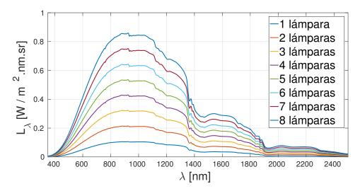
**Fig. 4.8**: Radiancia espectral en el centro de la boca de la esfera para 1 a 8 lámparas encendidas
