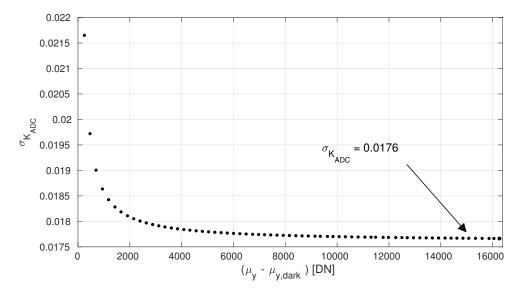
**Fig. 5.13**: Error en la estimación de  $K_{ADC}$  en función de la señal.
