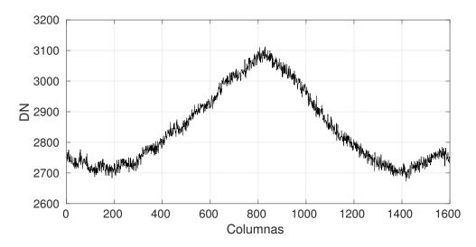
**Fig. 7.3**: Vignetting en la fila 600 del sensor ( $t_{int} = 5ms$ ).
