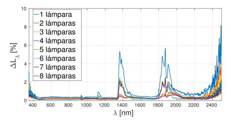
**Fig. 4.10**: Uniformidad espacial de la radiancia en el puerto de salida de la esfera integradora.
