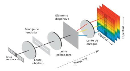
Fig. 3.2: Elementos de una cámara hiperespectral.
