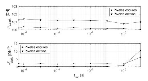
**Fig. 5.18**: Media y varianza de la señal oscura en función del tiempo de integración para 1 ADC.
