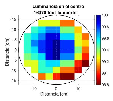
**Fig. 4.6**: Matriz de 69 puntos definida por el fabricante para medir la luminancia y determinar la uniformidad espacial en el puerto de salida de la esfera.
