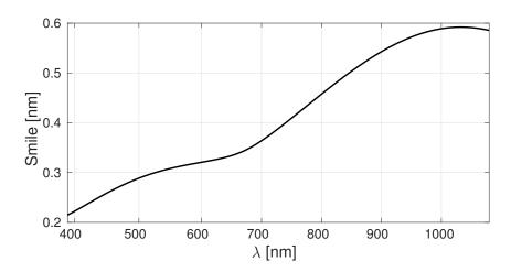
Fig. 6.15: Variación del smile en función de la longitud de onda.
