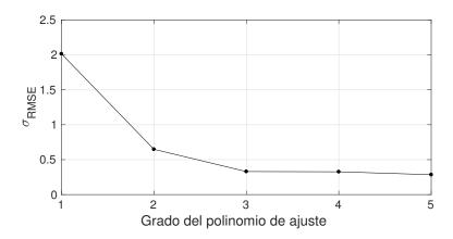
Fig. 6.8: Error de ajuste en función del grado del polinomio.
