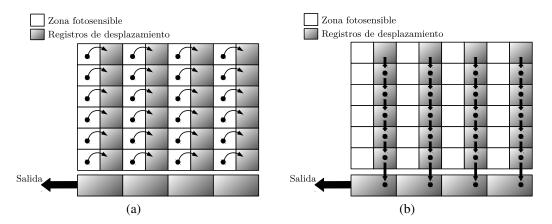
**Fig. 3.8**: Transferencia de carga en el CCD. (a) Transferencia de carga al registro de desplazamiento vertical; (b) Desplazamiento de las cargas hacia el registro de desplazamiento horizontal.
