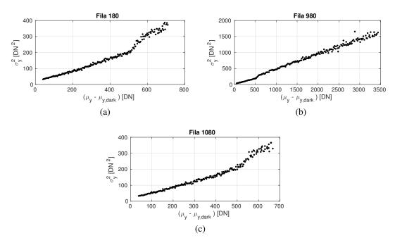
**Fig. 5.28**: Anomalías detectadas en el sensor CCD. (a) Fila 180; (b) Fila 980; (c) Fila 1080.
