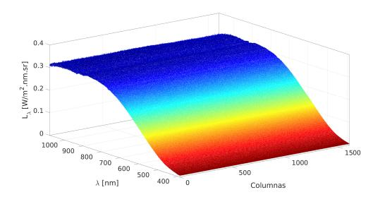
**Fig. 7.7**: Vista 3D de la calibración realizada.  $t_{int}=5ms$ , 3 lámparas encendidas.
