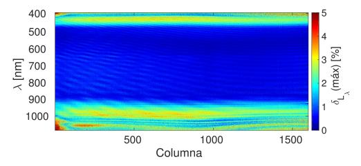
**Fig. 5.5**: Desviación de la linealidad  $\delta_{\lambda}(max)$  con la radiancia.
