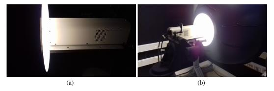
**Fig. 5.3**: Configuración utilizada para capturar imágenes con la cámara VNIR frente a la esfera integradora. (a) Vista lateral; (b) Vista lejana del sistema soporte, cámara y esfera.
