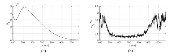
**Fig. 7.11**: Variación de la constante  $K_t$  en función de la longitud de onda para la columna 800 del sensor y 8 lámparas de la esfera integradora encendidas. (a) Constante  $K_t$ ; (b) Error porcentual  $\sigma_{K_t}$ .
