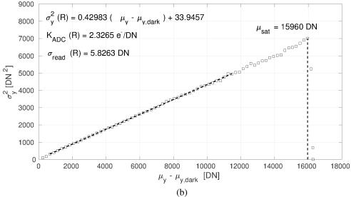
**Fig. 5.15**: Estimación de la ganancia  $K_{ADC}$ , Read Noise y  $\mu_{sat}$  para un pixel clock de 10MHz y 2 ADC. (a) Mitad izquierda; (b) Mitad derecha.
