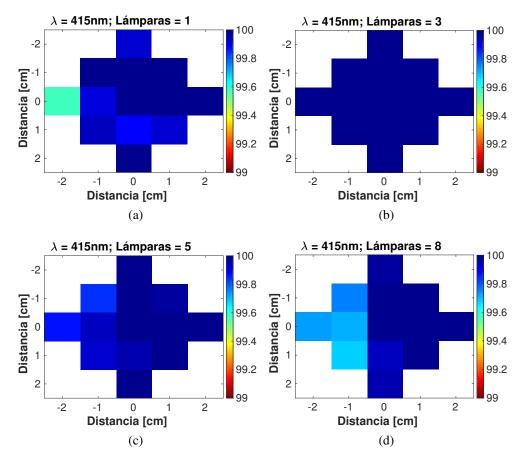
**Fig. 4.12**: Uniformidad para (a) 1 lámpara; (b) 3 lámparas; (c) 5 lámparas; (d) 8 lámparas.
