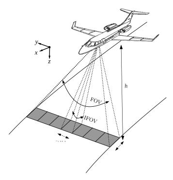
Fig. 2.4: Funcionamiento de un sensor push broom aerotransportado.
