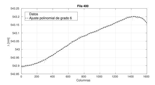
Fig. 6.12: Aberración producida por el sistema óptico del espectrógrafo.
