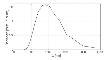
**Fig. 4.5**: Radiancias medidas por el fabricante en el centro del puerto de salida de la esfera integradora.
