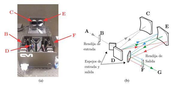
**Fig. 4.13**: Monocromador utilizado en este trabajo. (a) Monocromador desarmado; (b) Arquitectura Czerny-Turner.
