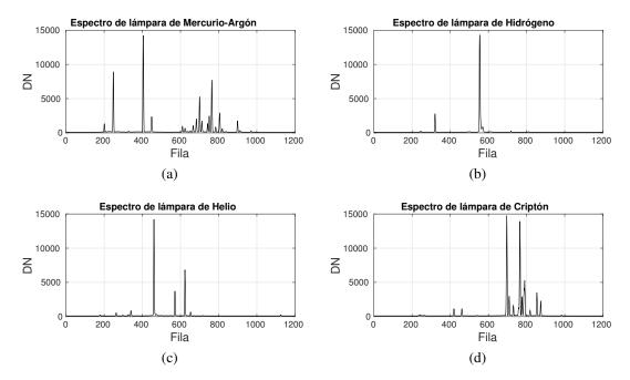
**Fig. 6.1**: Imágenes capturadas con la cámara VNIR frente a las lámparas de descarga para la columna central. (a) Mercurio-Argón (b) Hidrógeno; (c) Helio; (d) Criptón.
