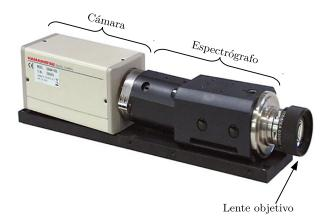
Fig. 3.1: Cámara, espectrógrafo y lente objetivo.
