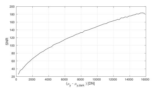
Fig. 5.21: Relación señal-ruido del sensor.
