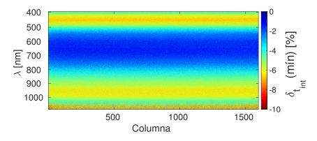
**Fig. 5.9**: Desviación de la linealidad  $\delta_{t_{int}}(min)$  con el tiempo de integración.
