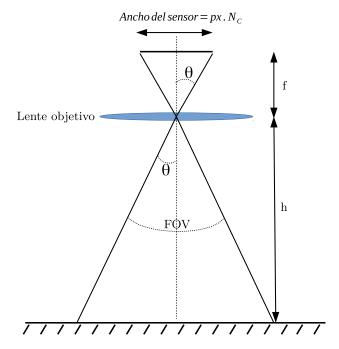
Fig. 3.3: Cálculo del FOV de la cámara.
