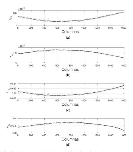
**Fig. 6.11**: Coeficientes de polinomios de calibración. (a)  $a_{3,j}$ ; (b)  $a_{2,j}$ ; (c)  $a_{1,j}$ ; (d)  $a_{0,j}$ .
