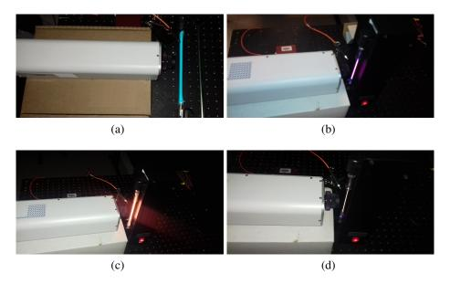
**Fig. 6.5**: Configuraciones de medición implementadas. (a) Mercurio-Argón (b) Hidrógeno; (c) Helio; (d) Criptón.
