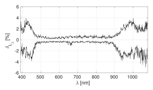
**Fig. 5.4**: Desviación de la linealidad  $\delta_{L_{\lambda}}$  con la radiancia para la columna 800.
