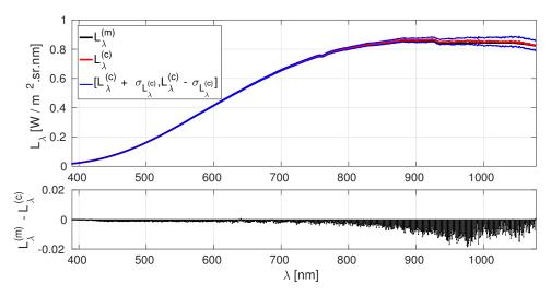
**Fig. 7.9**: Calibración realizada en una imagen con  $t_{int} = 5ms$ , y 8 lámparas encendidas en la esfera (columna 800).
