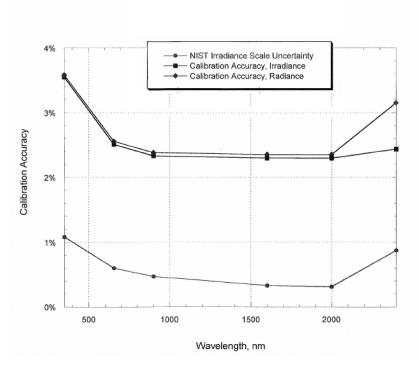
Fig. 4.2: Curvas de error del espectrorradiómetro, extraídas de su certificado de calibración.
