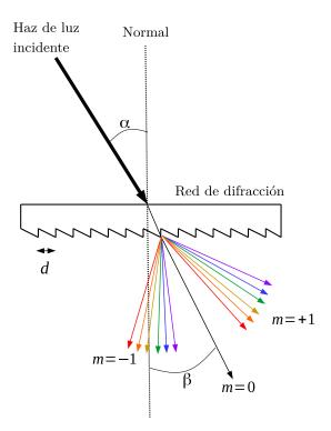
Fig. 3.5: Red de difracción transmisiva.
