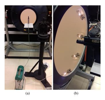
**Fig. 4.7**: Espectrorradiómetro frente a la esfera integradora. (a) Espectrorradiómetro en la parte inferior y sensor sobre el soporte mecánico frente a al puerto de salida de la esfera; (b) Vista lateral donde se ve el sensor del espectrorradiómetro, el puerto de salida de la esfera y sus lámparas internas.
