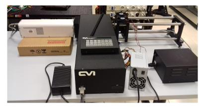
Fig. 6.6: Setup de la cámara frente al monocromador.
