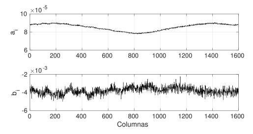
**Fig. 7.6**: Coeficientes de calibración para la fila 600 ( $t_{int} = 5ms$ ).
