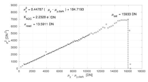
**Fig. 5.14**: Estimación de la ganancia  $K_{ADC}$ , Read Noise y  $\mu_{sat}$  para un pixel clock de 40MHz y 1 ADC.
