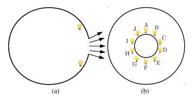
**Fig. 4.4**: Esfera integradora iluminada internamente con 10 lámparas halógenas de tungsteno. (a) Corte de vista lateral; (b) Disposición de lámparas alrededor del puerto de salida.
