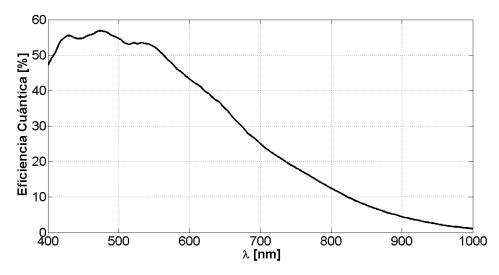
Fig. 3.10: Eficiencia cuántica del sensor.
