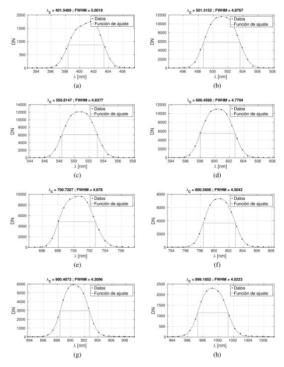
**Fig. 6.17**: Resolución espectral calculada con el monocromador para distintas longitudes de onda centrales en la columna 800 del sensor.
