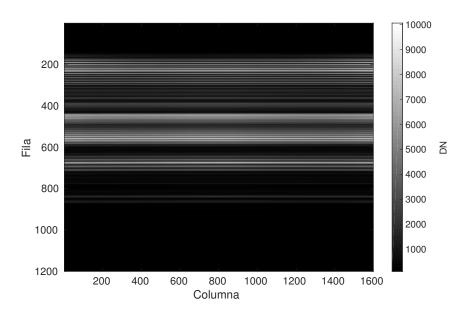
**Fig. 3.12**: Imagen hiperespectral capturada con la cámara VNIR frente a una lámpara de descarga de gases de Nitrógeno.
