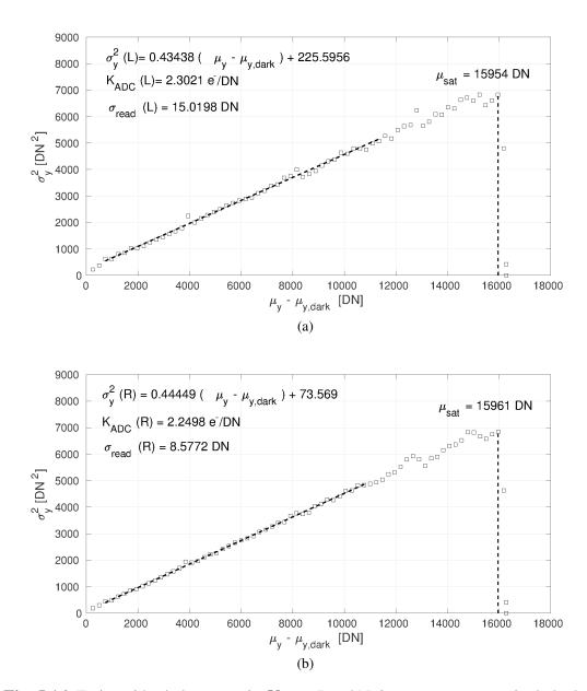
**Fig. 5.16**: Estimación de la ganancia  $K_{ADC}$ , Read Noise y  $\mu_{sat}$  para un pixel clock de 40MHz y 2 ADC. (a) Mitad izquierda; (b) Mitad derecha.
