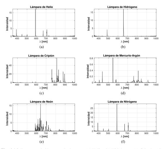
**Fig. 4.16**: Espectros de lámparas de descarga (a) Helio; (b) Hidrógeno; (c) Criptón; (d) Mercurio-Argón; (e) Neón; (f) Nitrógeno.
