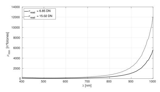
**Fig. 5.22**: Sensibilidad de la cámara hiperespectral considerando la transmitancia de la lente de 0.85.
