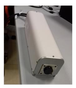
Fig. 5.17: Cámara VNIR tapada para las capturas de los Dark Frames.
