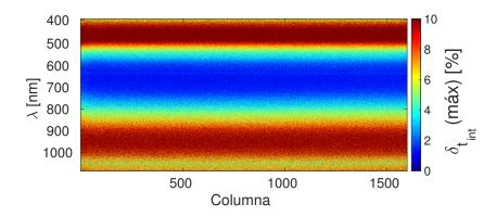
**Fig. 5.8**: Desviación de la linealidad  $\delta_{t_{int}}(max)$  con el tiempo de integración.
