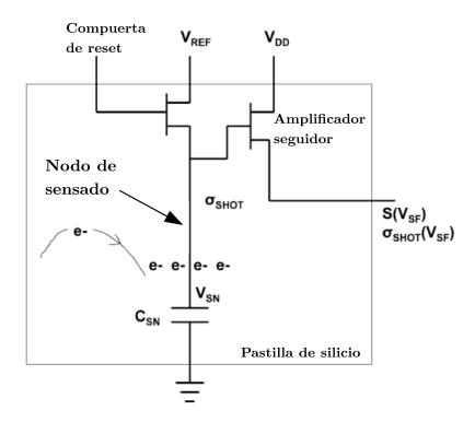
**Fig. 5.2**: Circuito simplificado típico de la región de un píxel que convierte los electrones capturados en los pozos de potencial en un voltaje.
