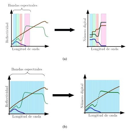
**Fig. 2.1**: Comparación entre imágenes multiespectrales e hiperespectrales. (a) Imagen multiespectral con 4 bandas, (b) Imagen hiperespectral con varias bandas contiguas.
