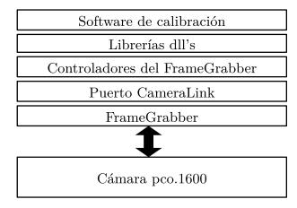
Fig. 3.17: Capas de comunicación entre la aplicación y la cámara pco.1600.
