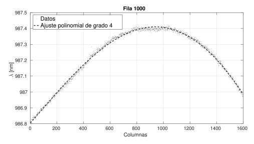
**Fig. 6.13**: Aberración producida por el sistema óptico del espectrógrafo, aquí es más evidente el fenómeno del smile.
