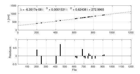
Fig. 6.9: Ajuste polinómico y residuos para la columna 800.
