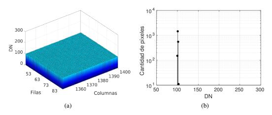
**Fig. 5.27**: Análisis de los hotpixels para  $t_{int} = 10ms$ .
