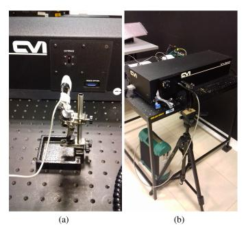
**Fig. 4.14**: Caracterización y alineación del monocromador. (a) Láser incidiendo en la rendija de entrada; (b) Sensor del espectrorradiómetro en la rendija de salida.
