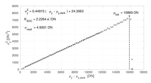
**Fig. 5.12**: Estimación de la ganancia  $K_{ADC}$ , Read Noise y  $\mu_{sat}$  para un pixel clock de 10MHz y 1 ADC.
