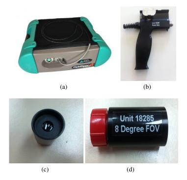
**Fig. 4.1**: Partes del espectrorradiómetro FieldSpec 4 Hig-Res. (a) Espectrorradiómetro y fibra óptica; (b) Agarre para fibra óptica; (c) Receptor de  $FOV = 8^{\circ}$  (lente objetivo del espectrorradiómetro); (d) Vista lateral del sensor de  $8^{\circ}$ .
