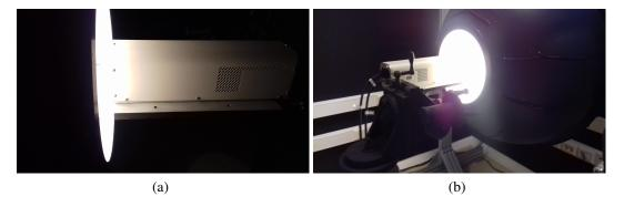
**Fig. 7.1**: Configuración utilizada para capturar imágenes con la cámara VNIR frente a la esfera integradora. (a) Vista lateral; (b) Vista lejana del sistema soporte, cámara y esfera.
