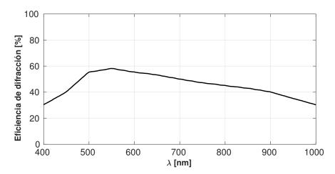
Fig. 3.6: Eficiencia de difracción de la red.
