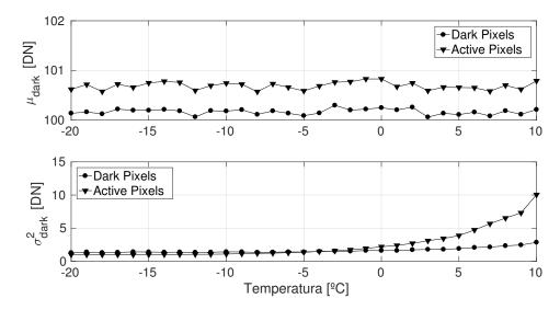
**Fig. 5.20**: Media y desviación estándar de la señal oscura en función de la temperatura para 1 ADC.
