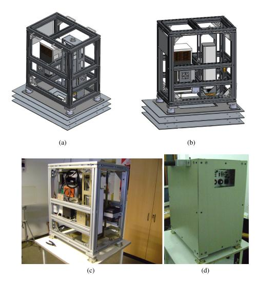
**Fig. 2.3**: Descripción general del sistema de captura de imágenes hiperespectrales aerotransportado. (a) Vista isométrica; (b) Vista lateral; (c) Gabinete destapado; (d) Gabinete tapado y sus conectores.
