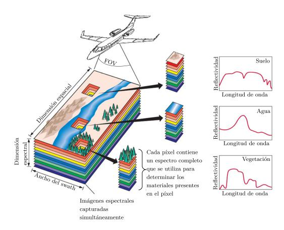
Fig. 2.2: Formación de imágenes hiperespectrales (adaptado de [19]).
