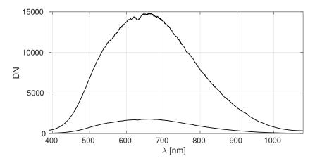
**Fig. 5.10**: Gráfico de los DNs en función de la longitud de onda para la columna 800, para 1 y 8 lámparas encendidas, con un  $t_{int} = 10ms$ .
