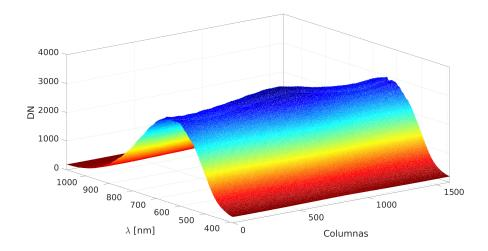
**Fig. 7.2**: Vista 3D de la imagen hiperespectral si calibrar.  $t_{int} = 5ms$ , 3 lámparas encendidas.
