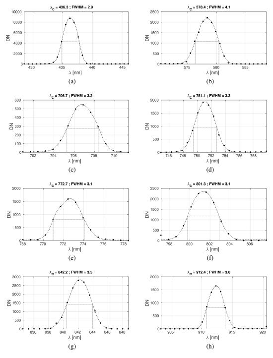
**Fig. 6.18**: Resolución espectral calculada con la lámpra de HgAr para distintas longitudes de onda centrales en la columna 800 del sensor.
