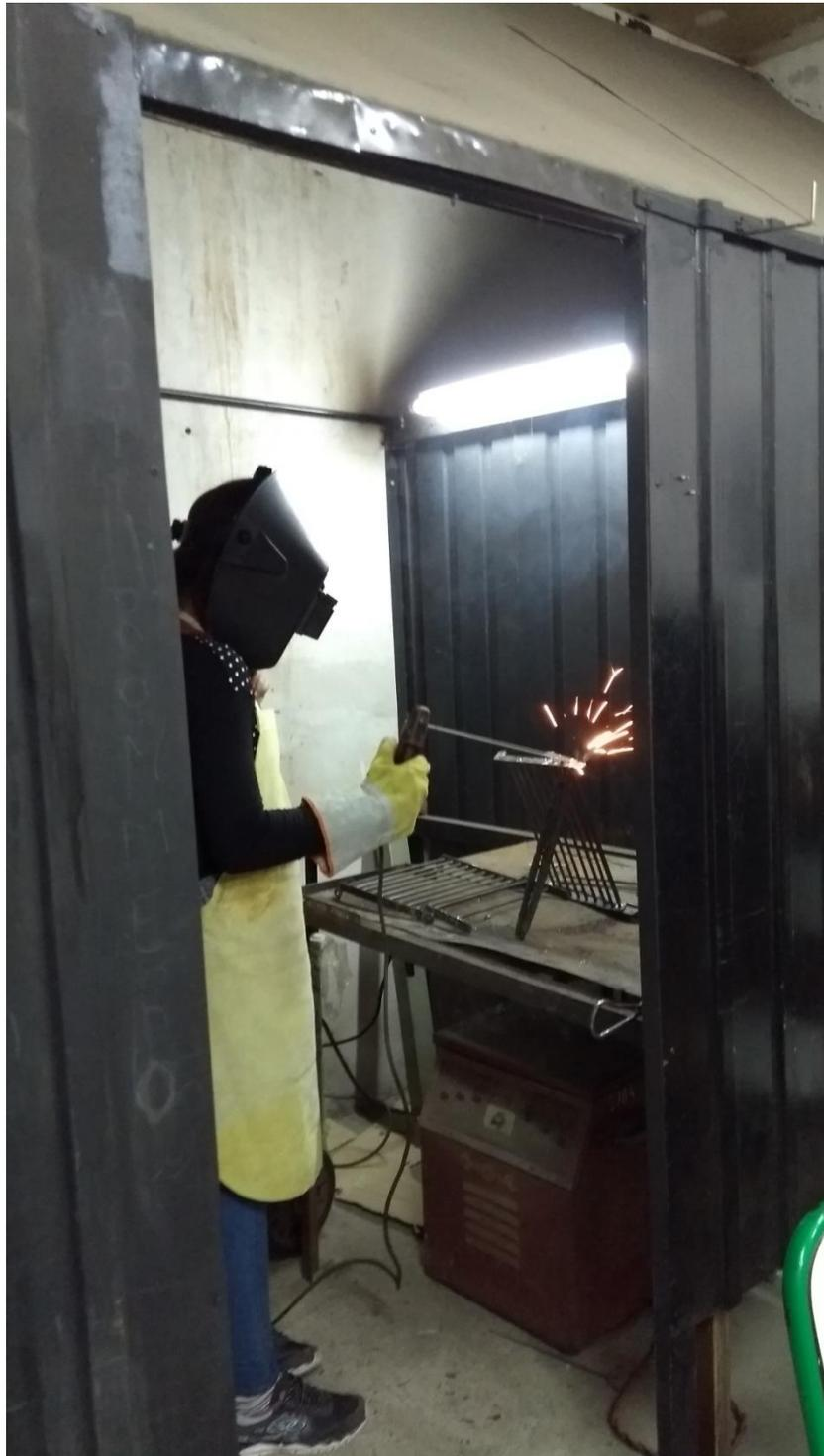
**TOMA DE MUESTRA PARA LA CAPTACIÓN DE CONTAMINANTES QUÍMICOS EN LA ATMÓSFERA DE TRABAJO DENTRO DEL TALLER DE SOLDADURA MIENTRAS SE REALIZA EL PROCESO DE FABRICACIÓN**
