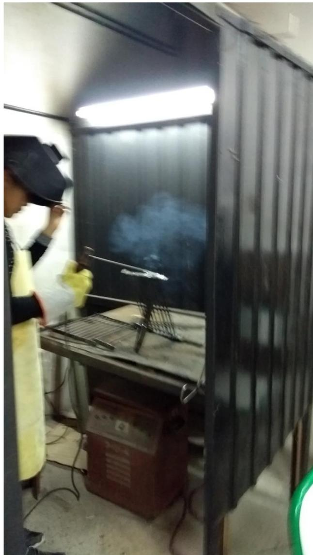
**Imagen donde se aprecian los humos que desprende la soldadura dentro del box.**
