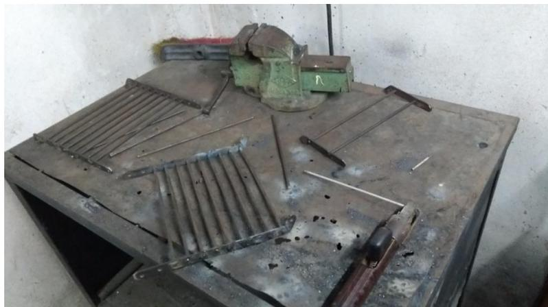
Para la construcción de la parrilla plegable se sigue un plano, en el cual describe el proceso de fabricación. Se trabaja con varillas de hierro las cuales luego de cortadas a medida, se las va soldando en las planchuelas laterales, las cuales fueron agujereadas con anterioridad.
