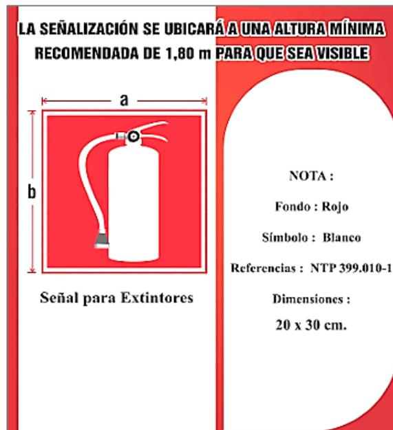
Figura 15-8: Visibilidad del rotulado de extintores.
