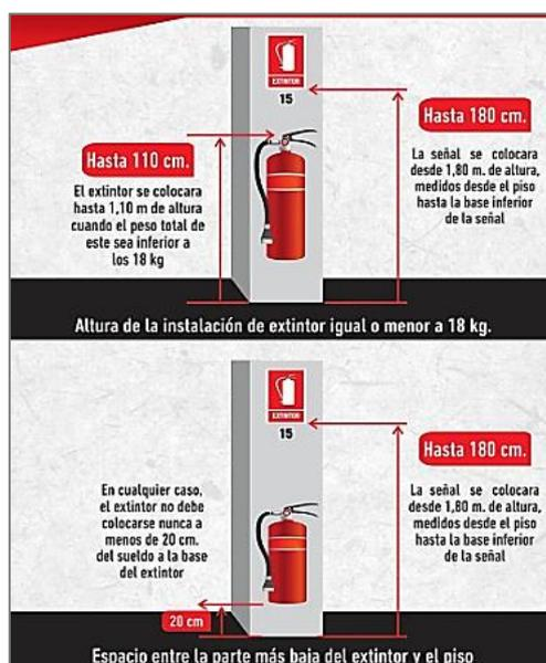
Figura 15-6: Altura de instalación de extintores.
