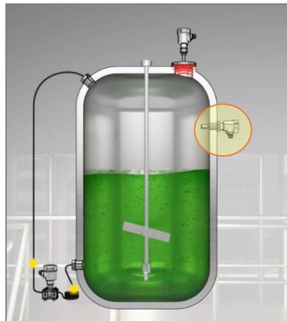
Figura 12-10: Ilustración de ubicación del sensor. Fuente: VEGA.
