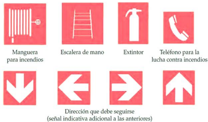
Figura 16.6. Señales relativas a los equipos de lucha contra incendios.
