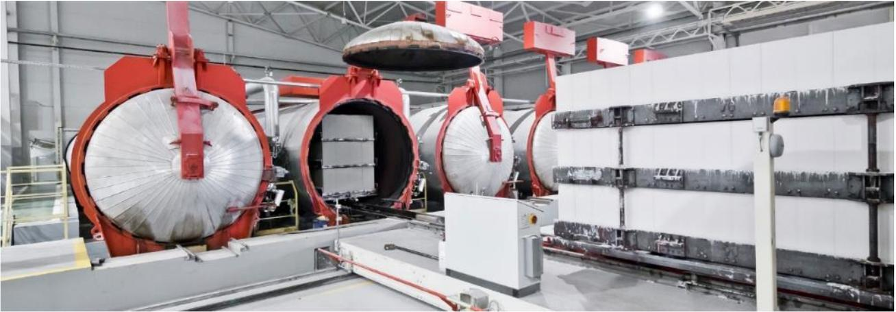
Figura 20. Disposición de 6 autoclaves industriales con aplicación en hormigón celular. Se observa el interior de uno de ellos a través de abertura tipo compuerta conteniendo torta de bloques. Fuente: WKB Systems GmbH, [www.wkb-systems.com](http://www.wkb-systems.com).
