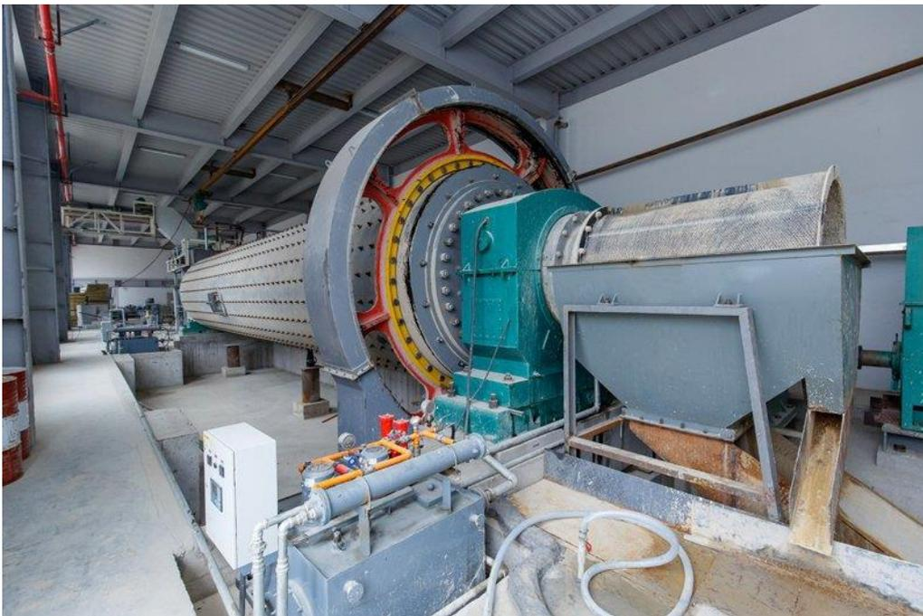
Figura 33. Molino de bolas de la firma TEEYER, con detalle de la salida de producto. Fuente: Jiangsu Teeyer Intelligent Equipment Corp., Ltd., <https://www.teeyer-aacline.com/1-2-2-ball-mill/179618/>.
