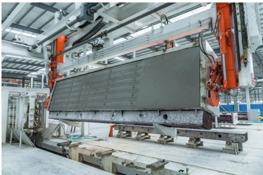
Figura 59. Puente grúa con brazo de volteo para moldes. Fuente: TEEYER, <https://teeyer-acline.com/6-3-rotating-hoister.html>.
