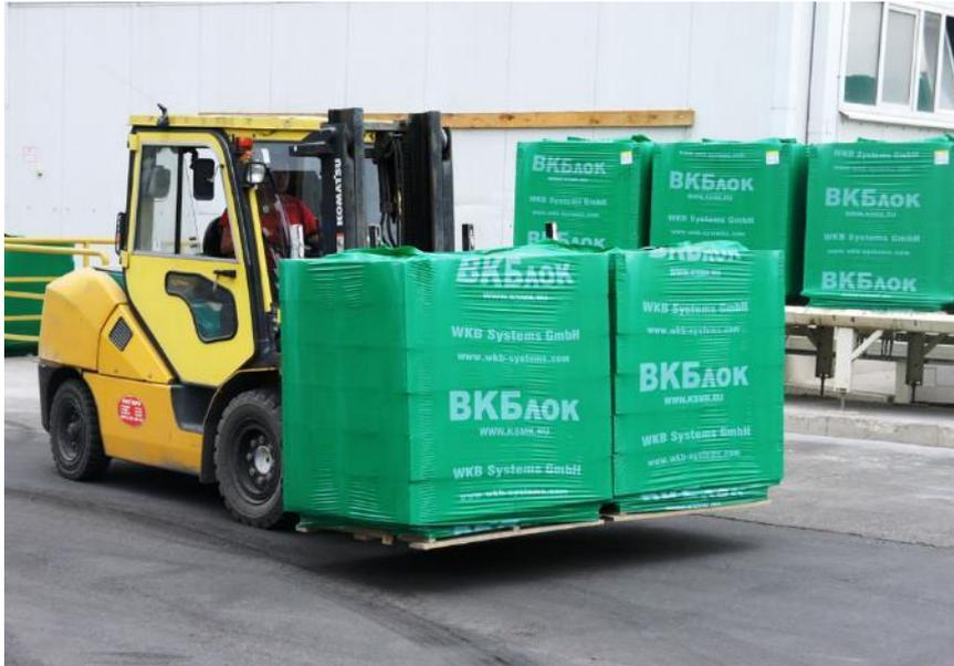
Figura 3. Bloques de HCCA envueltos en film plástico sobre paleta normalizada siendo acarreados por un autoelevador. Fuente: WKB Systems GmbH.
