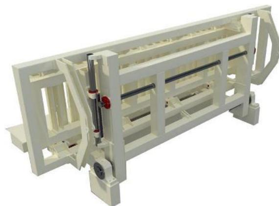
Figura 51. Vista de dispositivo basculante para voltear tortas de HCCA. Fuente: Sankon Tech, <http://aac-equipment.com/4-4-tilting-hange.html>.
