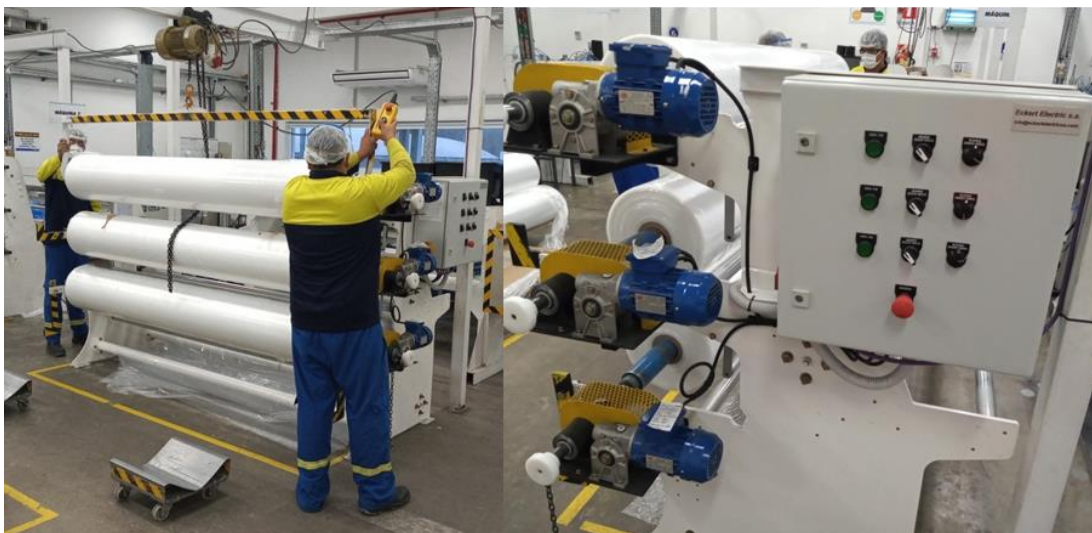
Fig. 5 Carga de bobinas y mecanismo de desbobinado automático.
