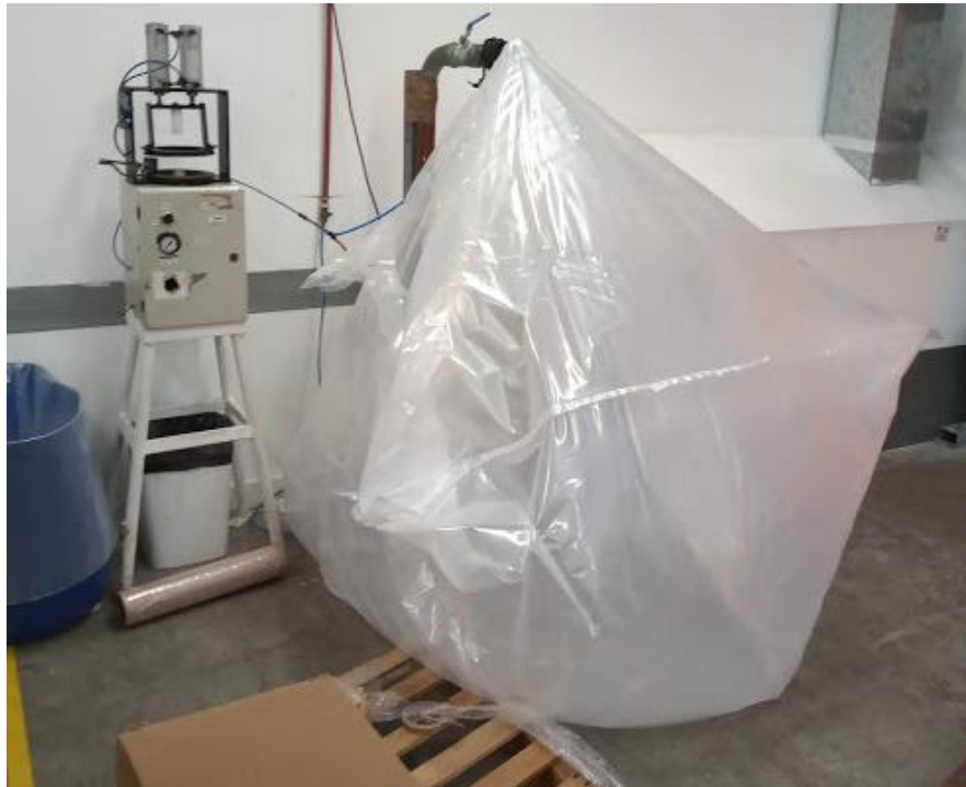
Fig. 8 Zona de control de calidad del producto mediante prueba hidráulica
