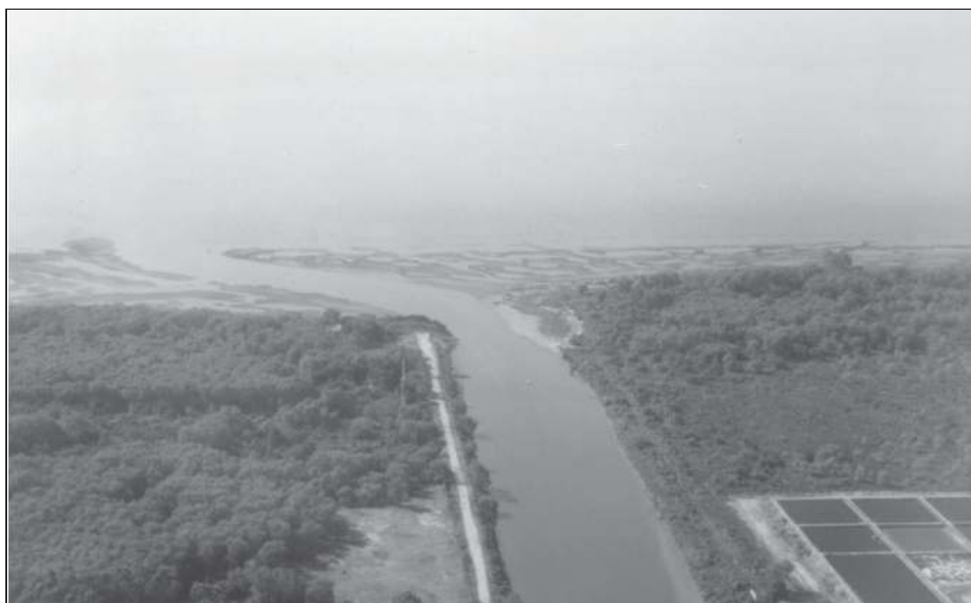
Imagen 2.3: Vista del curso del arroyo Sarandí desplazado hacia el norte por las corrientes de deriva litoral generadas durante las sudestadas. (Fuente: scielo.org.ar)
