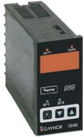
El NOVA96 es un pirómetro programable concebido con la máxima tecnología al mas bajo precio. El control de temperatura se puede realizar utilizando un sistema de control Fuzzy Logic con Autosintonía u ON - OFF, el cual ajustará los parámetros para efectuar un óptimo control. Como sensores de temperatura puede utilizar termocuplas tipo J, K, o termoresistencia PT100.
