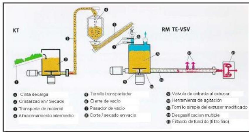
MC-F-003-Esquema de un sistema de tratamiento físico de tipo Vacurema
