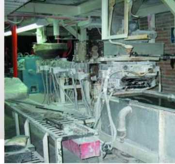
Foto; máquina extrusora de doble husillo utilizada para la realización de las pruebas de pellets. Se realizó polietileno con aserrín y con celulosa. Se utilizó para la producción piloto
