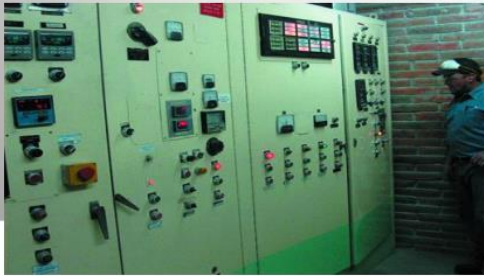
Foto: Un panel de control de una máquina doble husillo con alimentador lateral.
