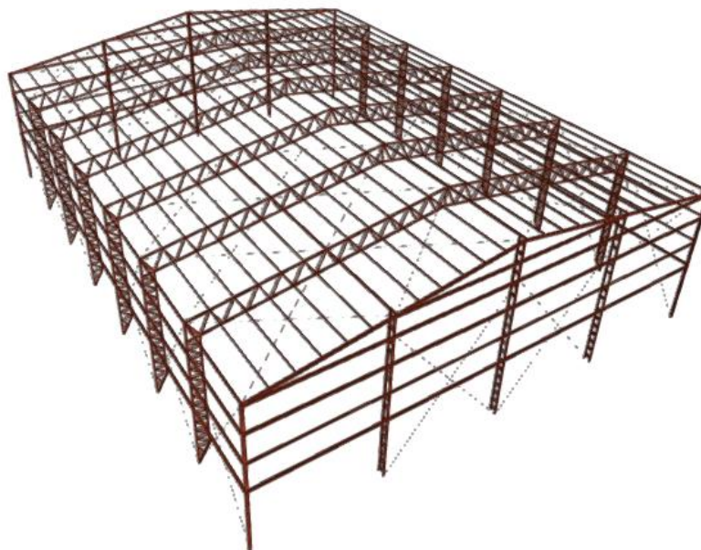
Figura 54 - Estructura metálica de la nave
