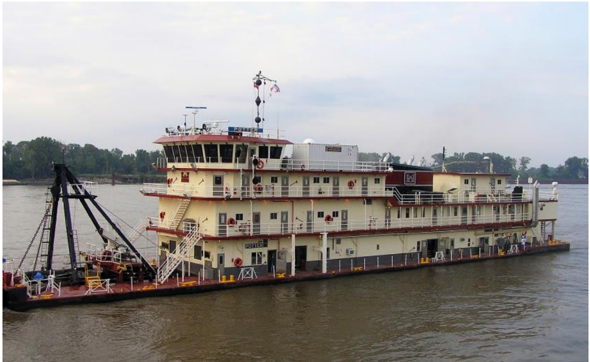
Figura 1.4 – Draga Potter tipo Dustpan
