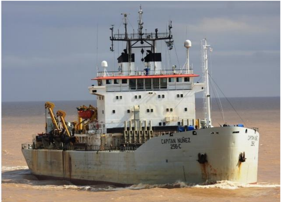
Figura 1.2 - Draga Tipo TSHD –
