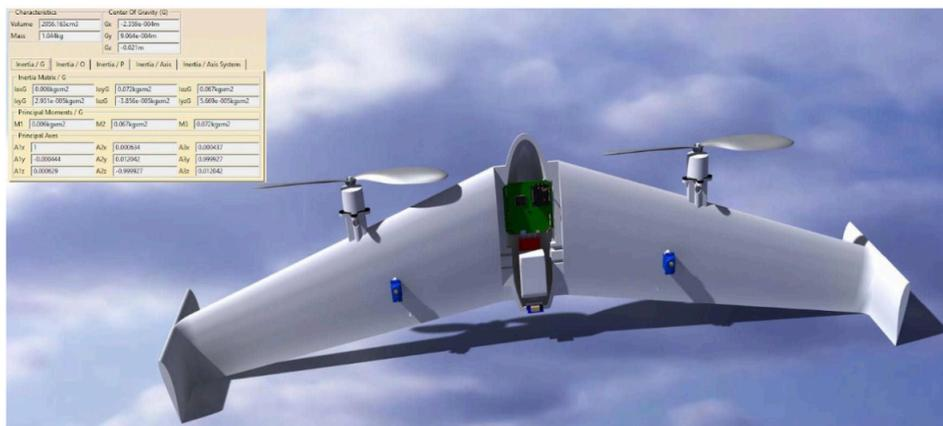
Fig. 6. Masa, centro de gravedad y matriz de inercia del prototipo
