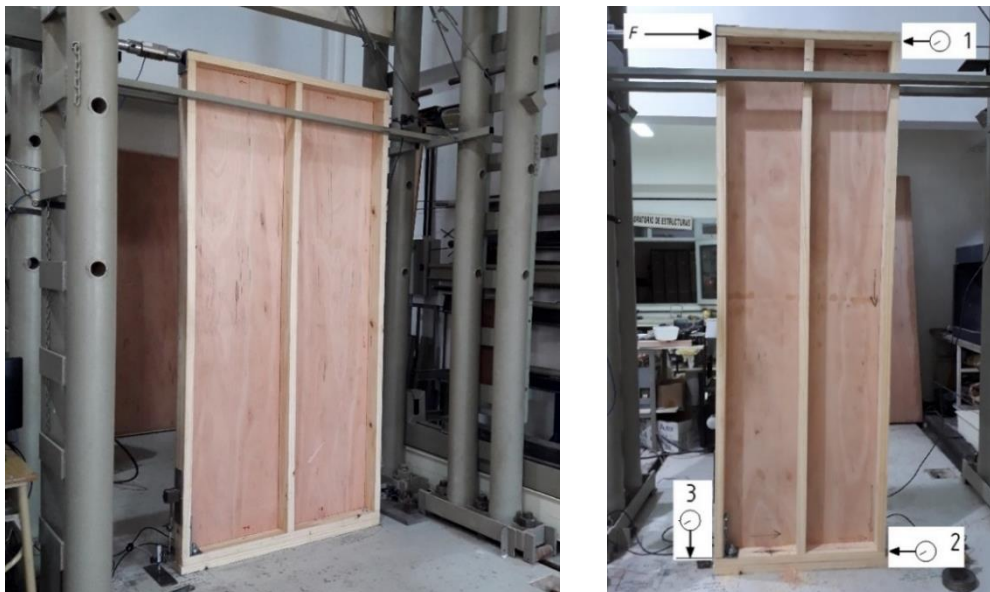
Figura 2 – Panel para ensayo. Izq.: 1,22m de ancho. Der.: 0,81m de ancho.
