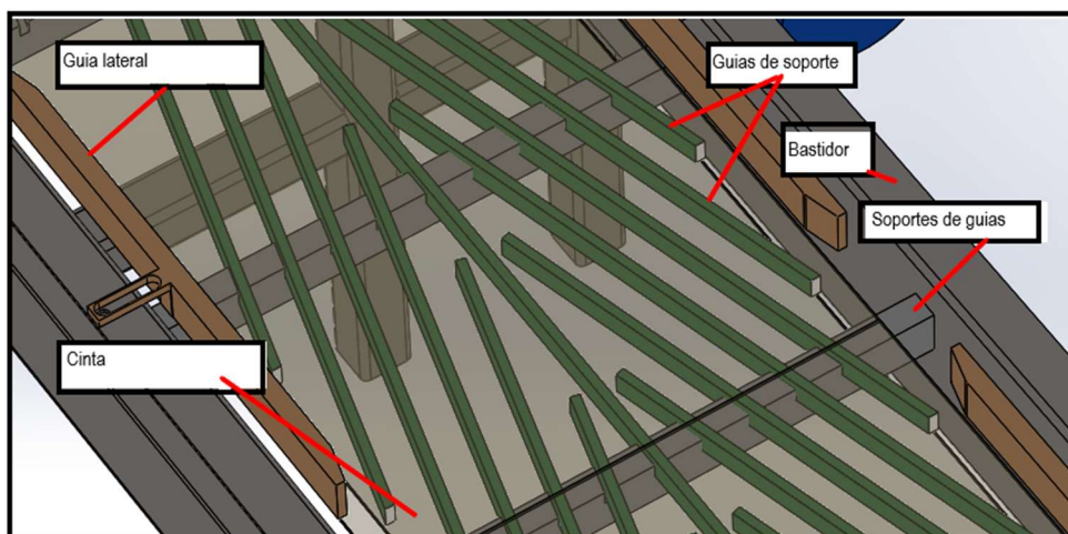
Ilustración 66 Disposición adoptada de guías de soporte de cinta
