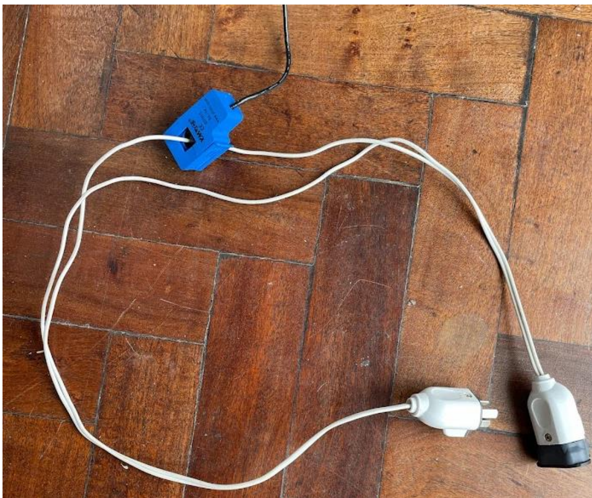
Fig. N° 48 Prolongación necesaria para medir la corriente.
