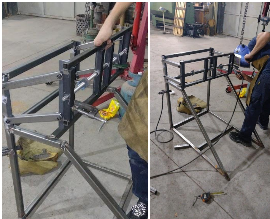
Sujeción y soldadura de sistema de agarre de pierna.
