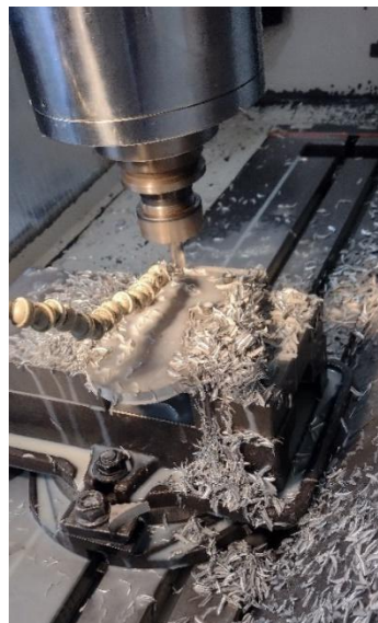
Fresado de primera pieza.
