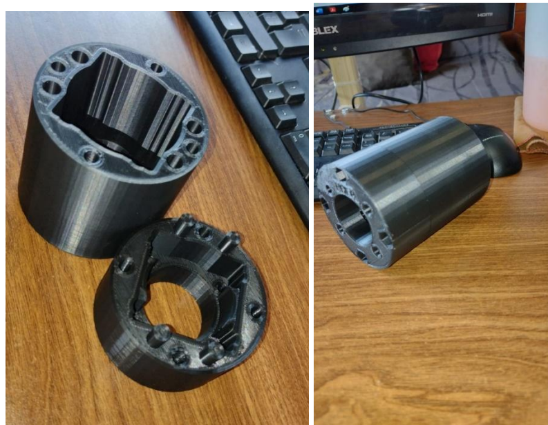
Impresión final sujeción de motor en ABS
