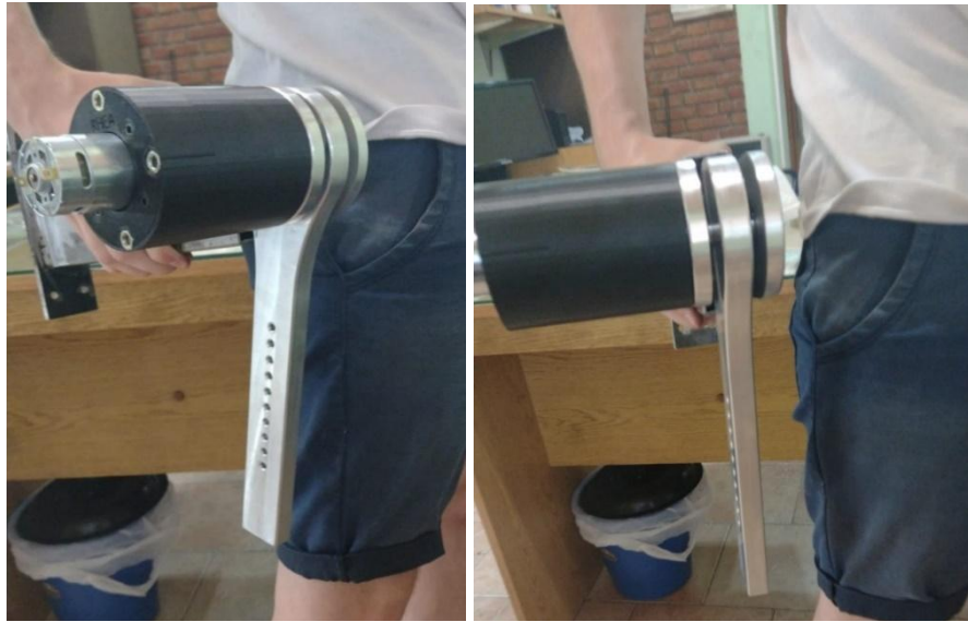
Articulación de muslo con motor ensamblada.
