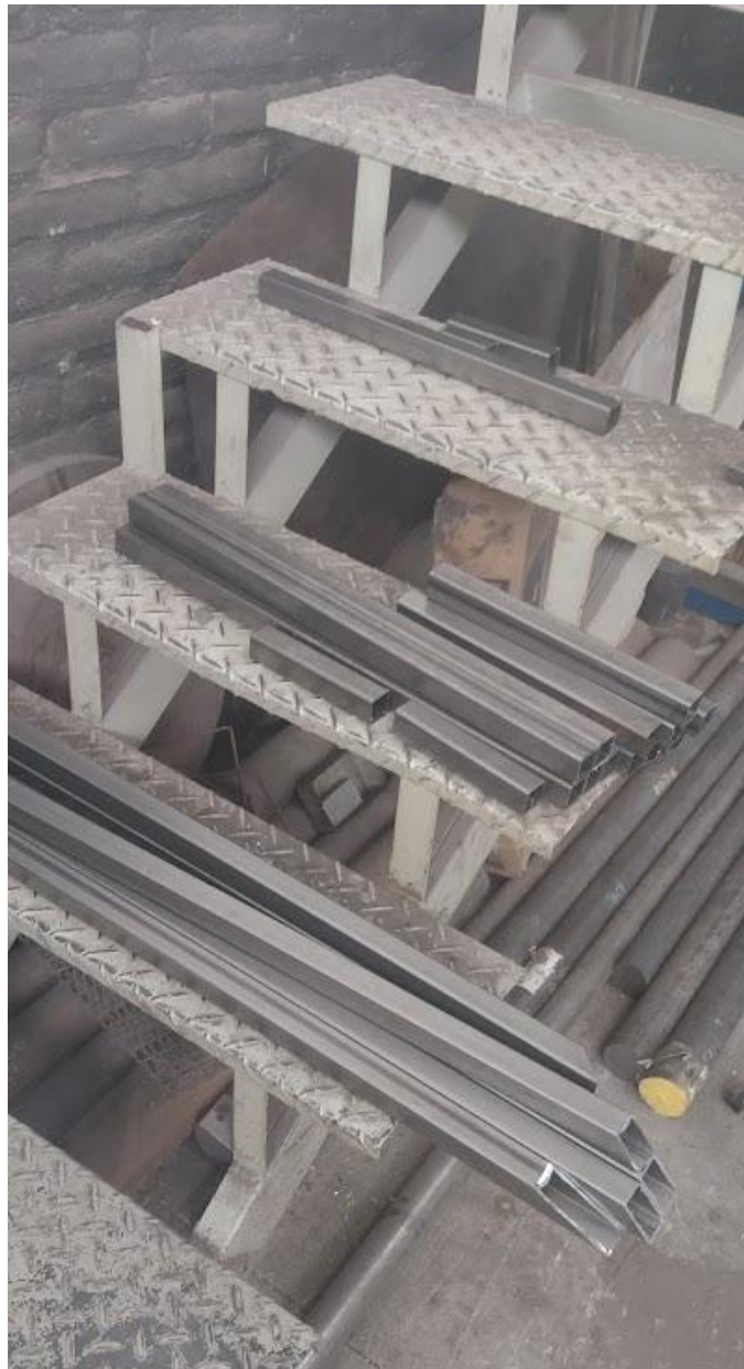
Corte de los perfiles para bastidor.
