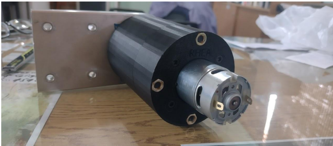
Molde final en ABS para motorreductor.
