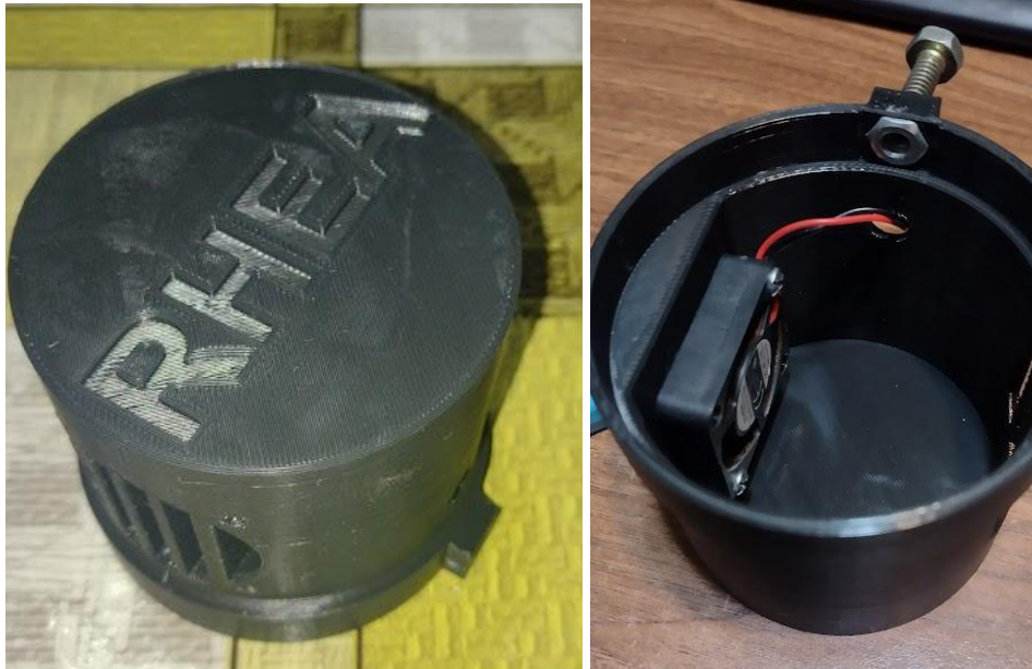
Impresión final de capuchón motor.
