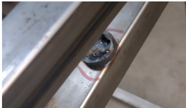
Corte y soldado de caño a la estructura del bastidor.
