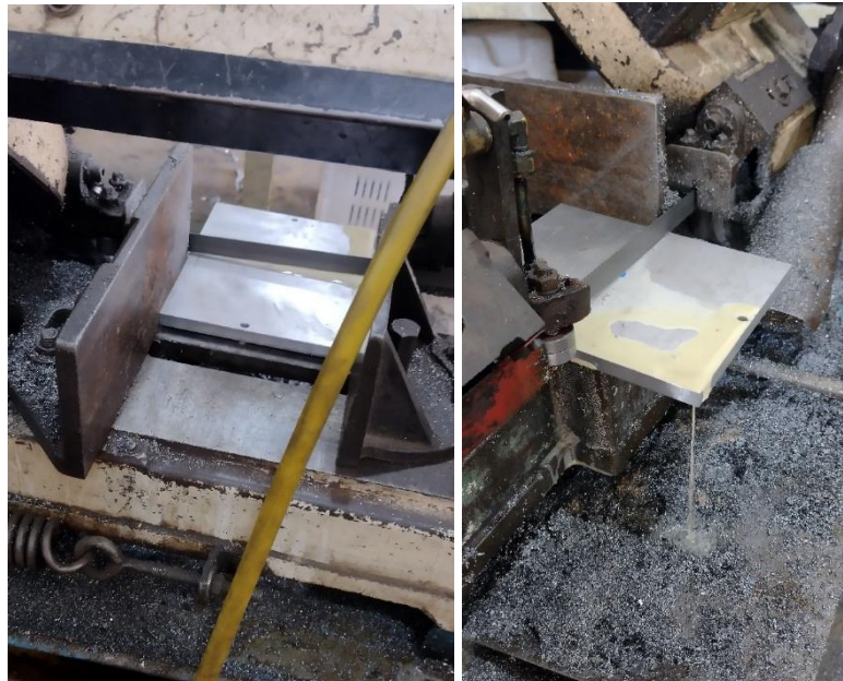
Corte de pieza maciza de aluminio por medio de serrucho motorizado.
