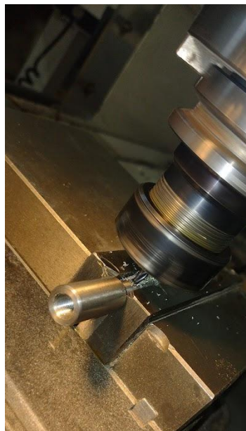
Roscado interno y chavetero del eje del motorreductor.
