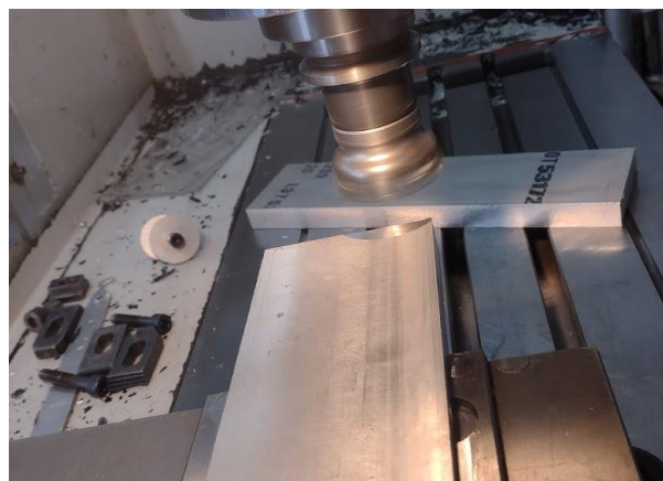
Frentado por medio de fresa CNC.
