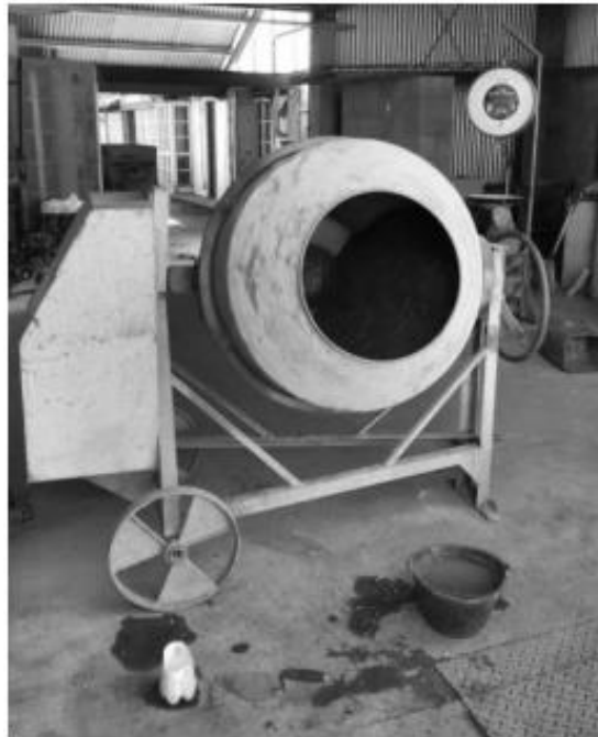
Figura 7. 3: mezcladora convencional utilizada en la etapa de mezclado y encapsulado.
