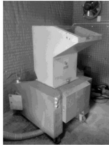
Figura 7. 2: trituradora de discos y un molino de cuchillas. Ambas necesarias para reducir el tamaño de las carcasas plásticas a 3-4 mm.
