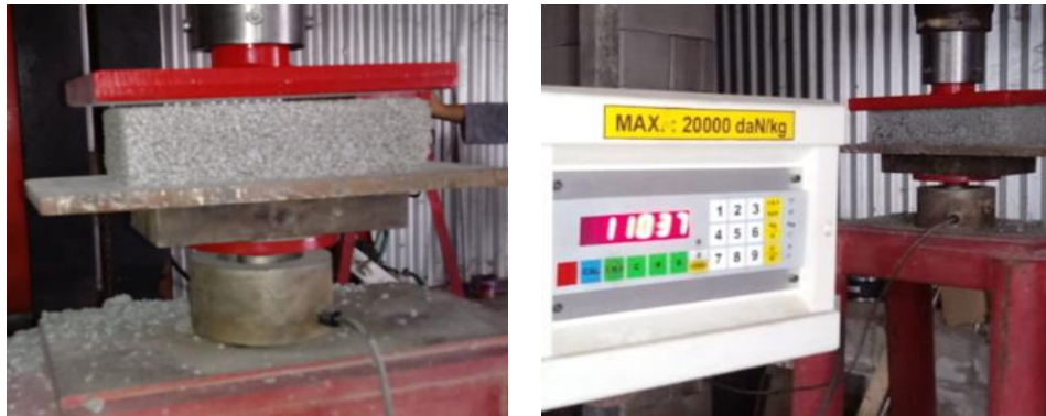
Figura 7. 9: ensayo de resistencia a la compresión en ladrillos de APR.
