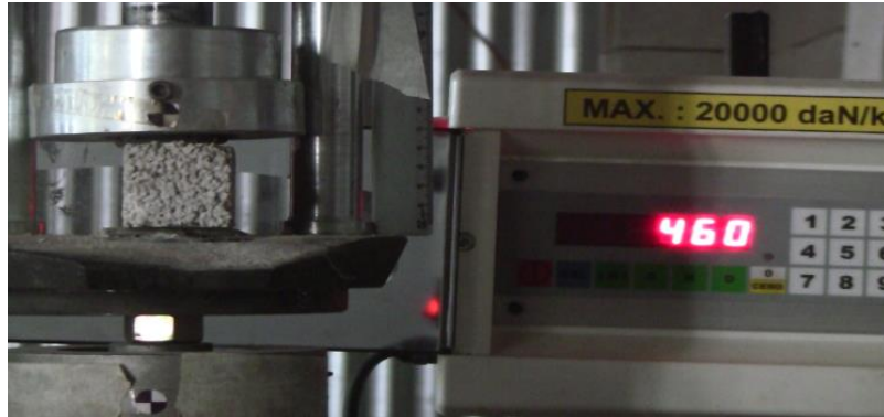
Figura A. 1: Probeta de mortero con APR siendo ensayada a compresión.
