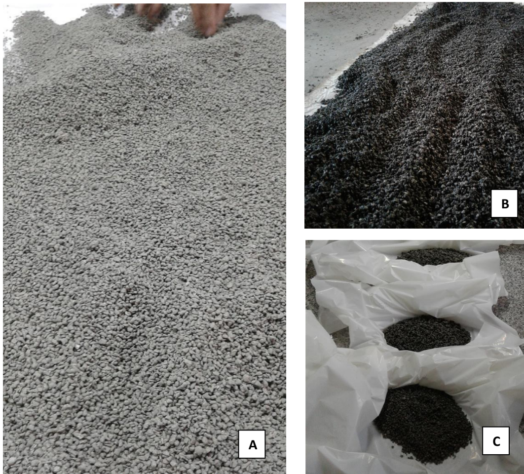
Figura 5. 4: En las fotografías A y B, se muestran los APR en proceso de secado a temperatura ambiente en un ambiente cerrado y seco. En la fotografía C, se muestra el APR tamizado y separado por tamaños.
