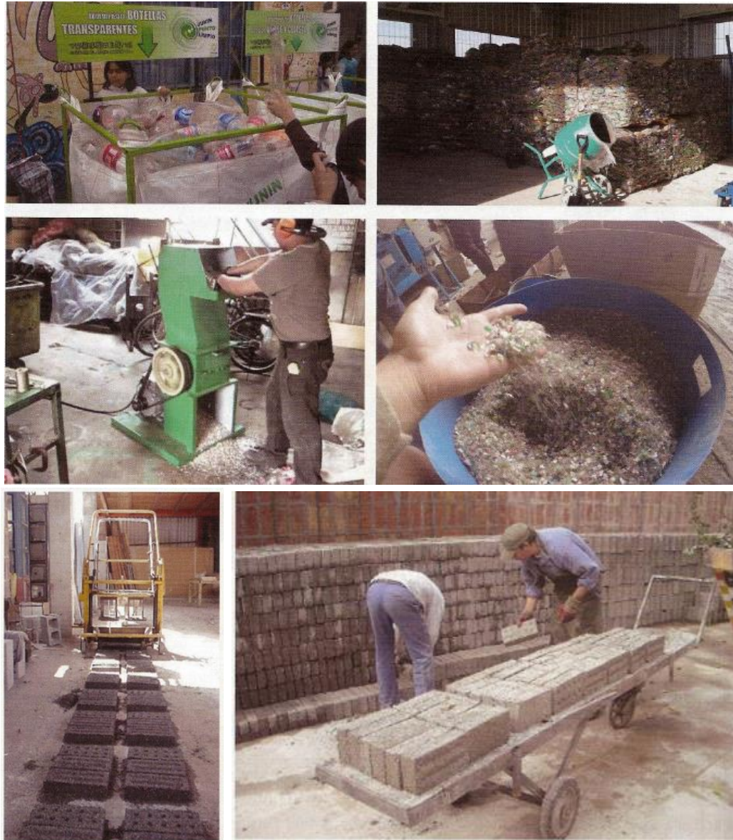
Figura 2. 8: Proceso de fabricación de ladrillos de PET .
