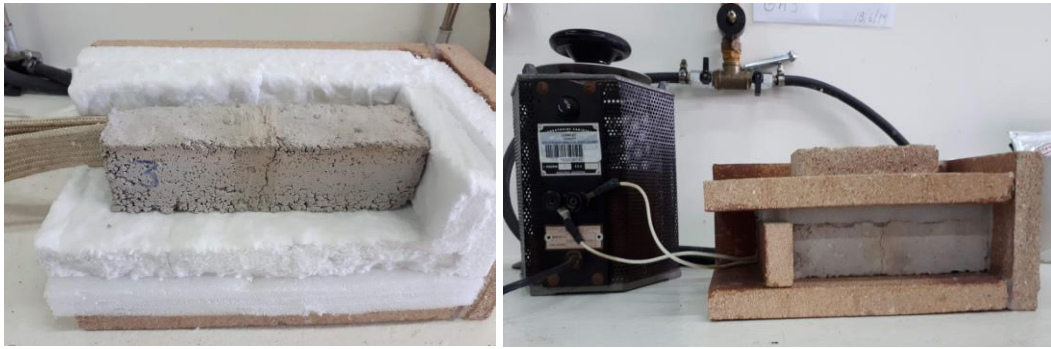
Figura 6. 15: Equipo usado para medir la conductividad térmica. Adaptación del equipo bajo la Norma IRAM 11559:1995.
