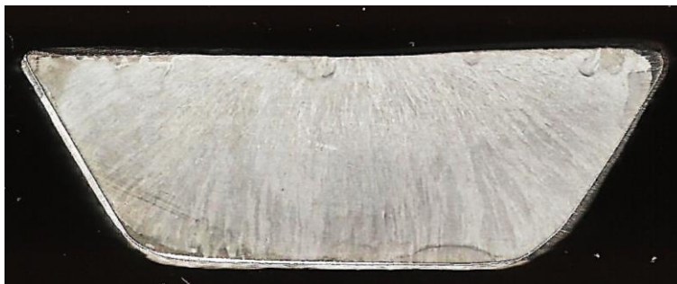
Figura 18. Imagen macrográfica de una sección transversal de lingote OK.
