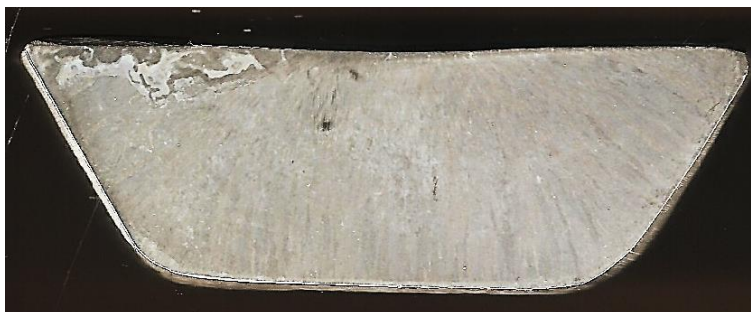
Figura 19. Imagen macrográfica de una sección transversal de lingote NOOK.
