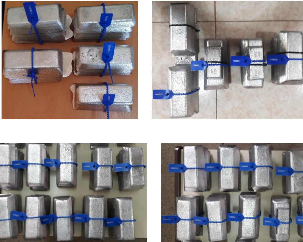
Figura 34. Lotes de lingotes entregados al cliente para su reutilización en el proceso de soldadura por ola de placas electrónicas.
