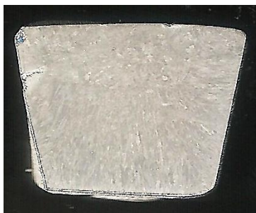
Figura 20. Imagen macrográfica de una sección transversal de la aleación de origen empleada en el proceso de soldadura.
