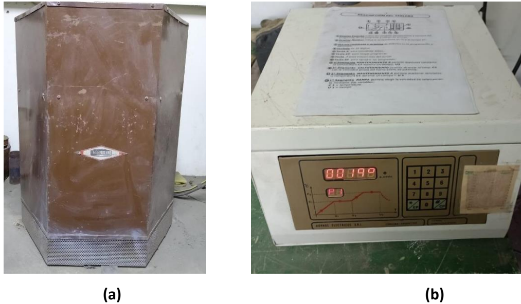
Figura 9. (a) Horno eléctrico. (b) Controlador.
