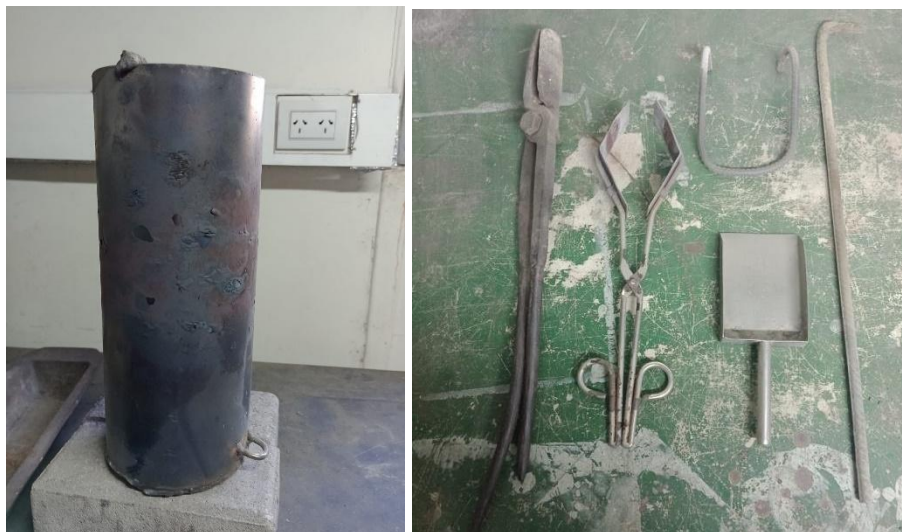
Figura 12. Crisol (izquierda). Herramental de manipulación y colada (derecha).
