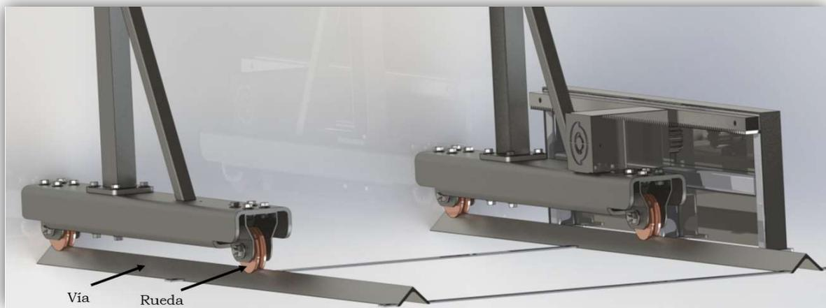
*Imagen 181: Sistema de movimiento horizontal.*
