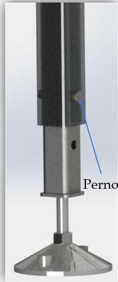
*Imagen 201: Sistema de regulación de altura.*
