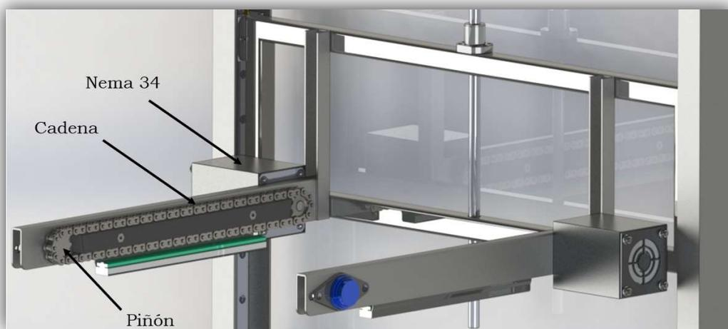
*Imagen 130: Sistema de transmisión para el transporte de los cuadros.*
