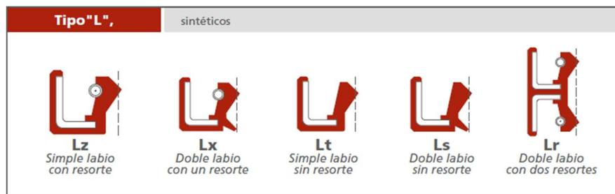
Ilustración 204: Reten Tipo L
