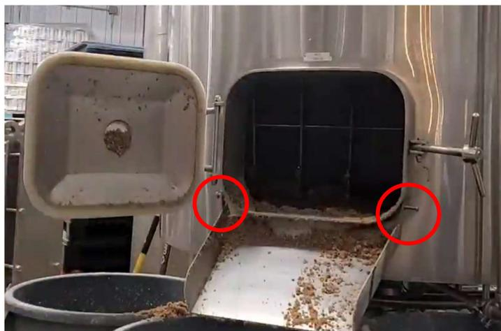
**Ilustración 226:** Chapa Desmontable
