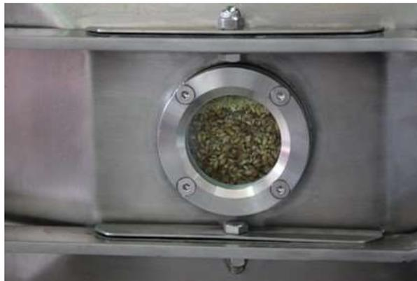
**Ilustración 225:** Mirilla Plana en Compuerta Lateral
