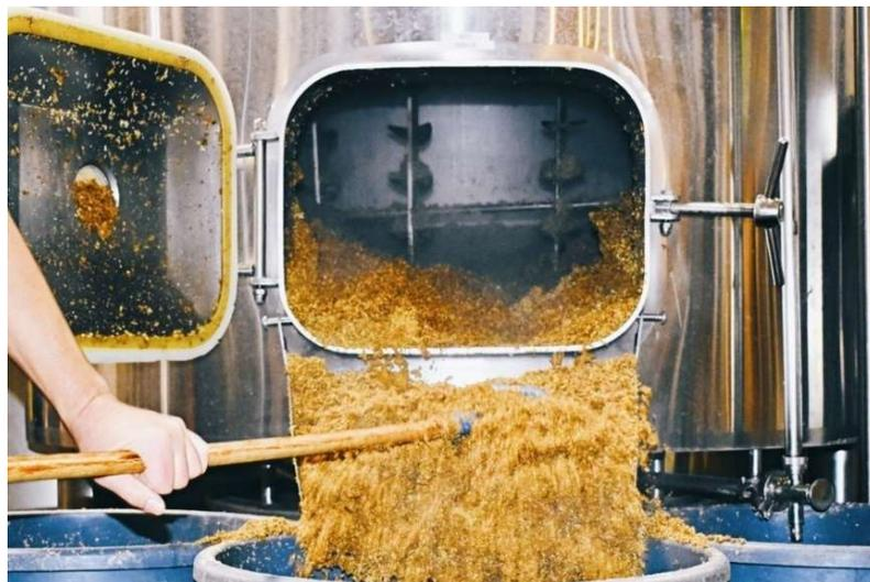
*Ilustración 18: Extracción Manual de Bagazo*
