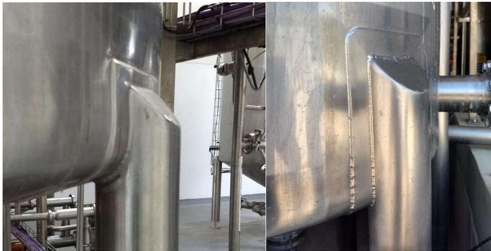
*Ilustración 180: Unión Tanque - Pie de Máquina II*
