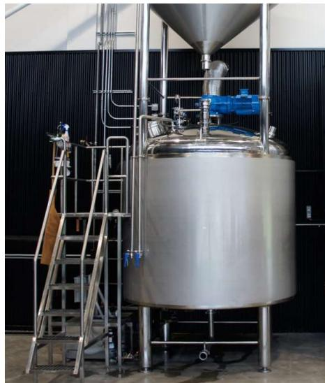
**Ilustración 20:** Macerador de Destilería NOLA, USA
