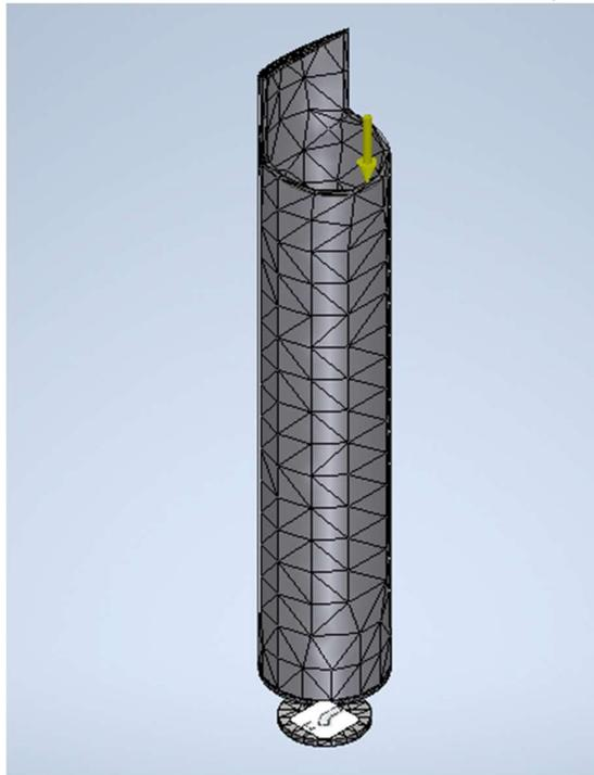
**Ilustración 186:** Cargas y Mallado
