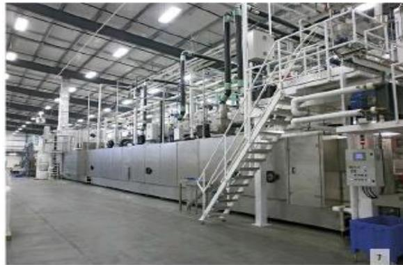
Con tecnología de secado PDT-HT. Cuenta con tratamiento continuo de ventilación y recuperación en todas las áreas de la secadora. La circulación de aire debe ser tal que asegure un secado uniforme a lo largo de la misma. Cuenta con diferentes áreas de secado, esto se requiere para tener un mayor control del proceso, aumentar la eficiencia energética y reducir la superficie total de la secadora.
