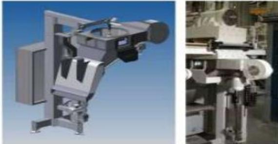
Es la máquina que corta la pasta en el molde por medio de cuchillas rotantes en acero especial. Las lamas son fijadas en cuchillas intercambiables a 1, 2 y 3 lamas. Cuenta con un sistema de cambio de molde por medio de un doble cajón corredizo, con tiempos de setup que van de 5 a 8 minutos.
